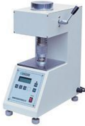
Materialın və boyanın sürtünməyə davamlılığını müəyyən etmək üçün – UGT-7034-RUB cihazı
