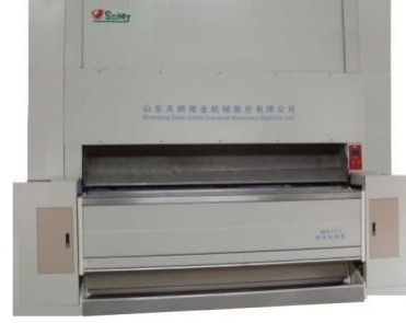
Şəkil 1.9 Çiyidi mahlıcdan ayıran mişarlı maşın batareyası görünüşü
