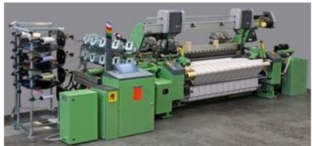
Şəkil 2.3 Pnevmatik elektron toxucu dəzgahı AS
