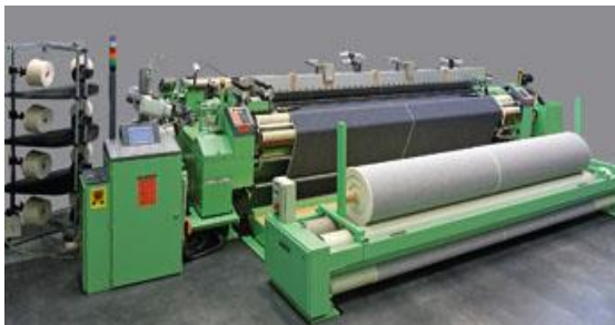
Şəkil 2.2 Pnevmatik toxucu dəzgahı PS
