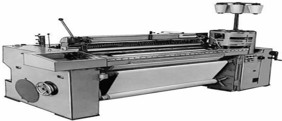
Şəkil 2.1 Z Mexaniki toxucu dəzgahının sxemi Dornier firması
