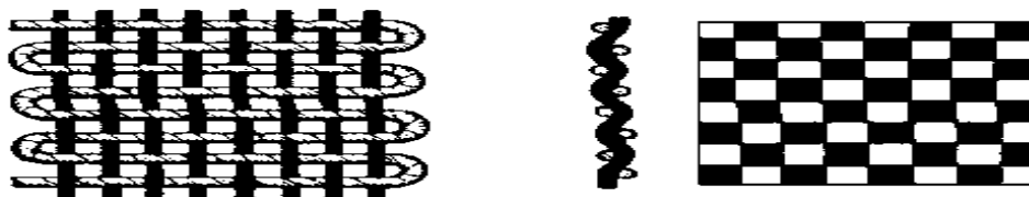
Şəkil 2.18 Kətan toxuma və onun kəsiyi
