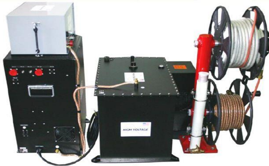
Şəkil 4.1. 110 kv tikilmiş polietilen izolyasiyalı kabellərin sinusoidal gərginliklə sınaq edilməsi üçün müasir tipli avadanlıq VLF-120 CMF
