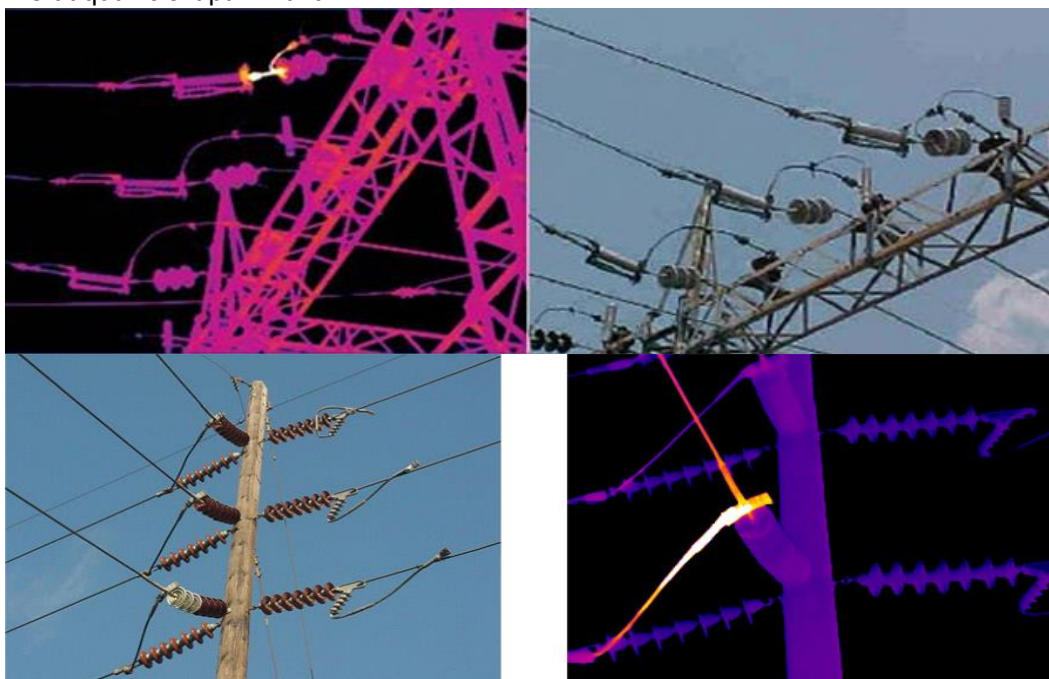
Şəkil 1.7. İstilikvizion ölçmə vasitəsilə hava xəttində zədə yerinin təyini
