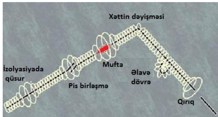
Şəkil. 2.1. Çəkilməmiş kabel xəttində zədə yerlərinin müəyyənləşdirilməsi
