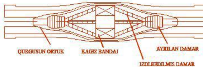
Sxem 2.2. SS tipli RUS muftasının əsas elementləri Rus markalı SS tip - qurğusunun örtüklü, birləşdirici muftanın əsas elementləri
