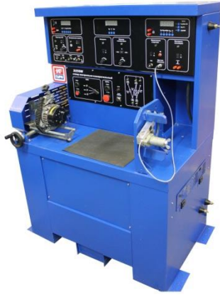
Şakil 3.22 Starter və generatorların yoxlanması üçün qurğu
