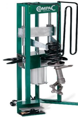
Şakil 3.23 Asqı yaylarının çıxarılması və qurulması üçün press CSC - Conpac
