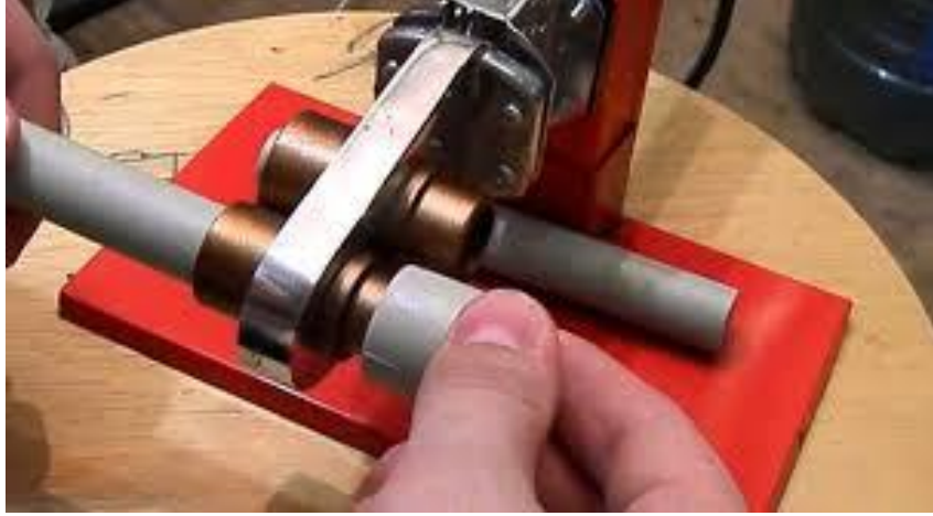
Şəkil 3.40. Polipropilen boruların qaynağı
