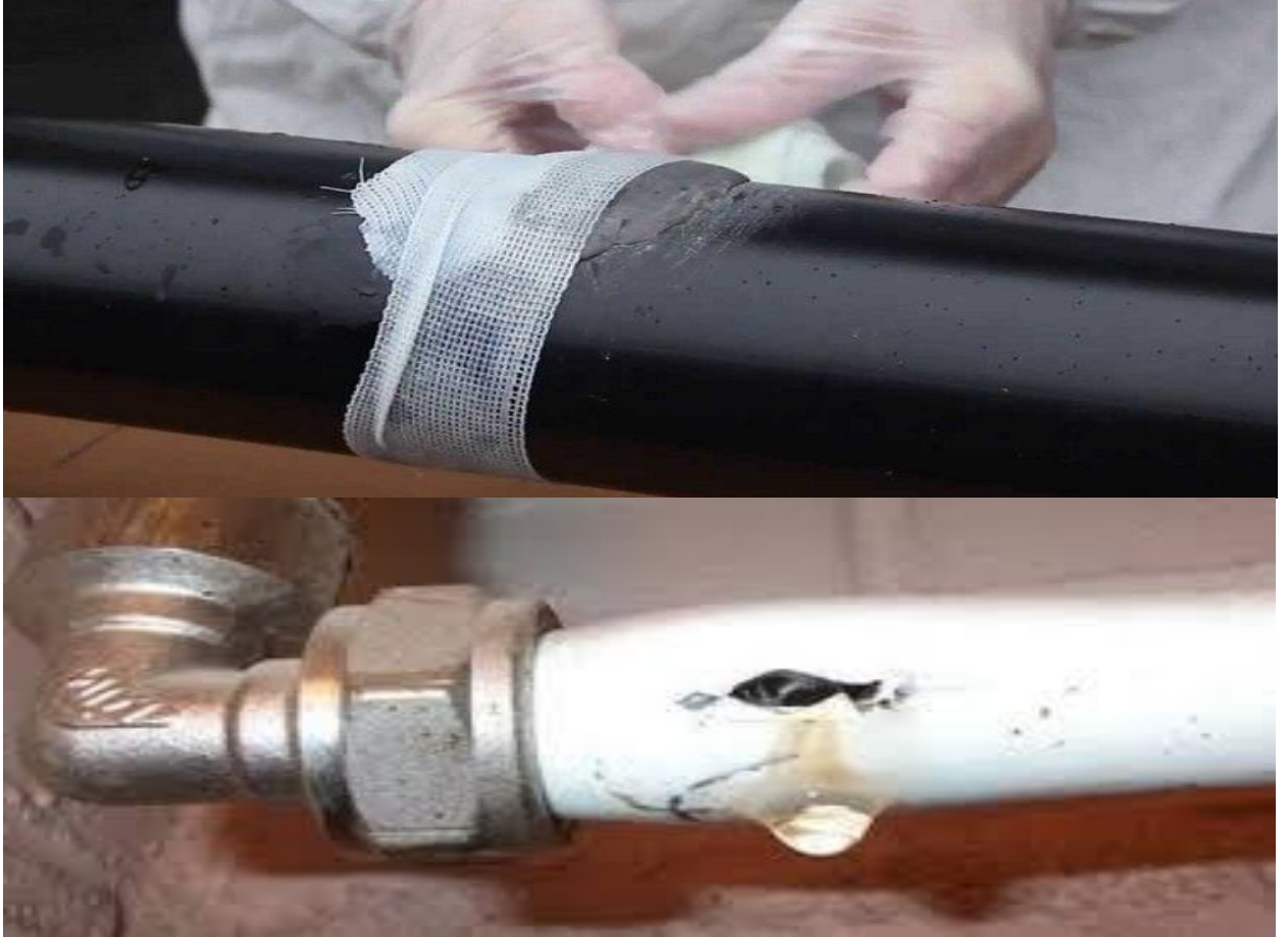
Şəkil 3.41. Polipropilen borularda zədələnmələr
