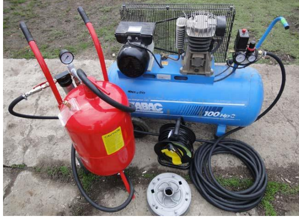
Şəkil: 1.2. Hava kompressoru
