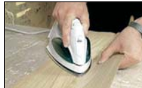
Şəkil 8. Ütü vasitəsilə sponun yapışdırılması
