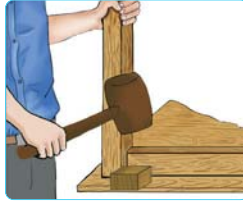
Şəkil 4. Bərkidilmələrin boşaldılması üçün taxta çəkicinin tətbiqi
