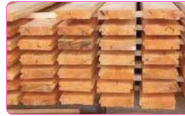
Şəkil 1. Mişar materiallarının təbii qurudulması
