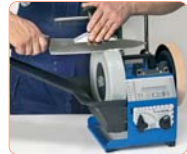
Şəkil 2. Bıçağın elektrik itiləmə dəzgahında itilənməsi
