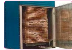
Şəkil 2. Mişar materiallarının qurutma kamerasında qurudulması
