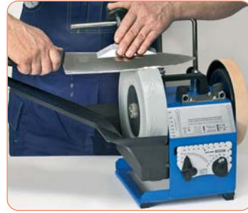
Şəkil 2. Bıçağın elektrik itilmə dəzgahında itilməsi
