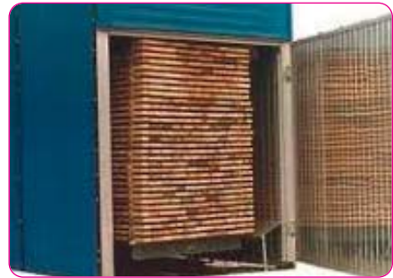
Şəkil 2. Mişar materiallarının qurutma kamerasında qurudulması
