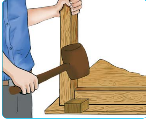
Şəkil 4. Bərkidilmələrin boşaldılması üçün taxta çəkicin tətbiqi
