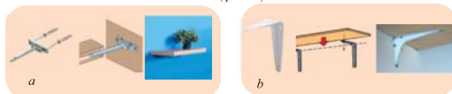
Şəkil 1. Xüsusi bərkidicilərin köməyi ilə bərkitmə üsulları: a - görünməz (daxili mil), b - görünən (kronşteyn**)
