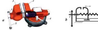
Şəkil 2. Məngənə: a – məngənənin quruluşu (1 – vint; 2 – hərəkətsiz dodaq; 3 – hərəkətli dodaq; 4 – dayaq çatısı; 5 – dəstək (ling)); b – məngənənin sxemi
