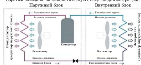
Рис. 5. Кинематическая схема кондиционера
