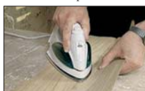
Рис. 8. Наклеивание шпона с помощью утюга
