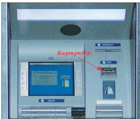
Рис. 3. Верхняя передняя часть банкомата
