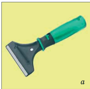
Рис. 8. а) скребок; б) удаление краски скребком
