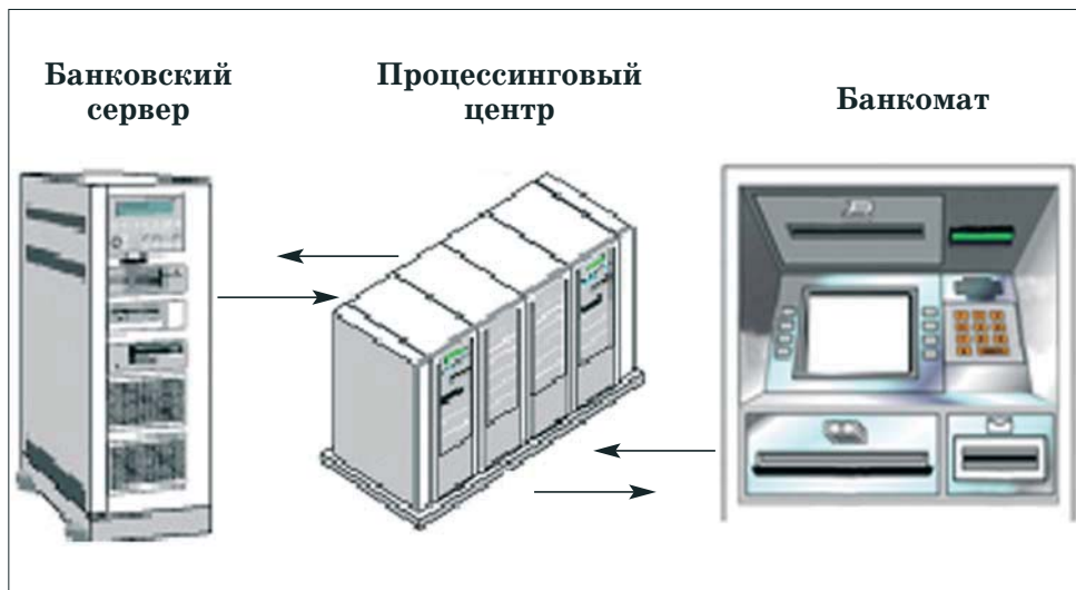
Рис. 9. Схема принципа работы банкомата
