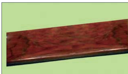
Рис. 3. Деталь, покрытая морилкой и лаком
