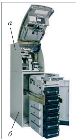
Рис. 2. Части банкомата: а) верхняя; б) нижняя
