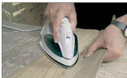
Рис. 8. Наклеивание шпона с помощью утюга
