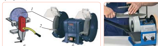
Рис. 1. а – ручной точильный станок; б – электрический точильный станок; 1 – точильный камень; 2 – упор
