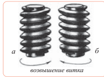
Рис. 4. Виды резьбы по направлению витка: а – правая резьба; б – левая резьба
