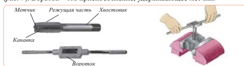
Рис. 7. Нарезание внутренней резьбы метчиком
