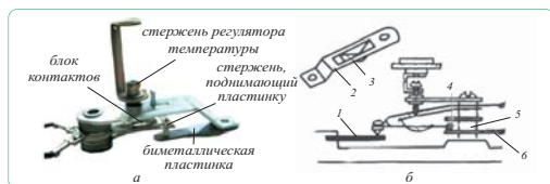
Рис. 3. а – терморегулятор; б – схема регулирования температуры
