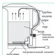
Рис. 2. Устройство электрического чайника
