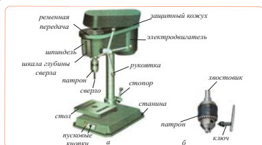
Рис. 1. а – устройство сверлильного станка; б – сверлильный патрон
