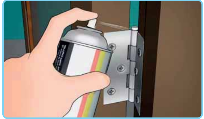
Qapı rəzəsi asanlıqla açılıb-bağlanmaq üçün yağlanır.
