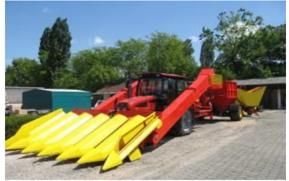
Şəkil 5.13. Qarğıdalı yığan 6 cərgəli PKK-6 (ПКК-6) kombaynı
