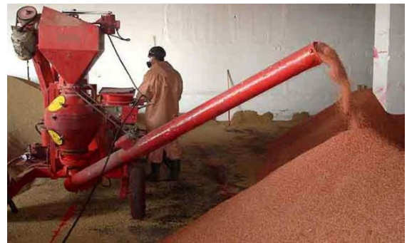
Şəkil 3.21. Toxumların xüsusi cihazla dərmanlanması
