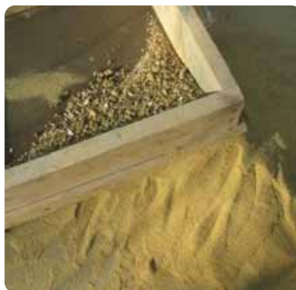
Песок, прежде чем использовать его в строительстве, просеивают через специальные сита с мелкими отверстиями.
