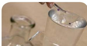
Удержание иголки на поверхности воды в стакане
