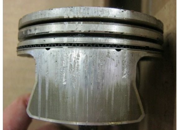
Şəkil 3.38. Porşenin halqalarının yeyilməsi ixrac qazlarında iyin əmələ gəlməsinə səbəb olur
