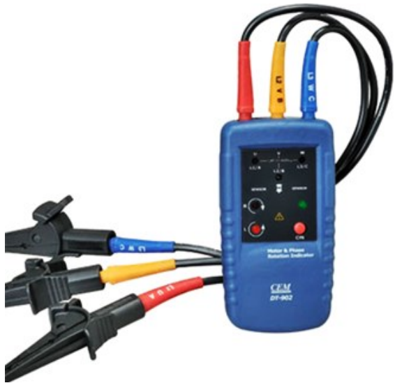
Şəkil 4.21. Elektrik avadanlıqlarının sarğılarının ardıcılığını müəyyən edən indikator
