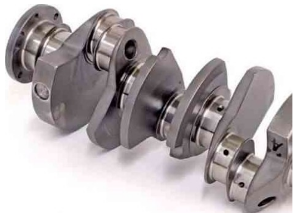
Şəkil 3.34. Mühərrikin dirsəkli valında yeyilmədən əsas və sürgüqolu boyunlarında araboşluqları əmələ gələ bilər
