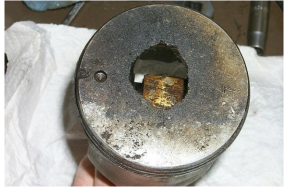
Şəkil 3.33. Detonasiya nəticəsində porşenin deşilməsi baş verə bilər
