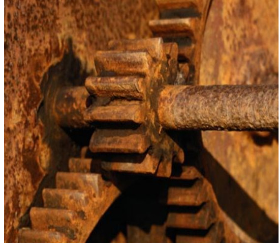
Şəkil 4.26. Texnikanın mexanizmləri yaxşı qorunmadıqda korroziya nəticəsində tez sıradan çıxır
