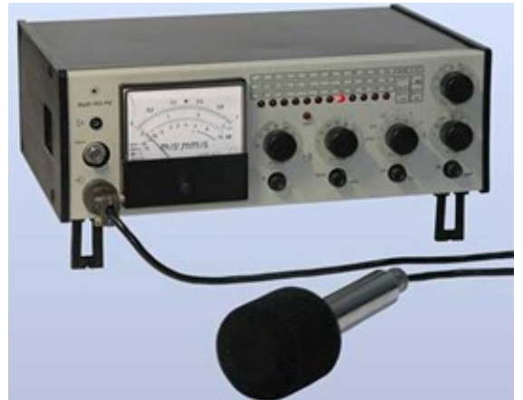
Şəkil 5.20. Səs diapazonu ölçən VŞV - 003 - M2 cihazı
