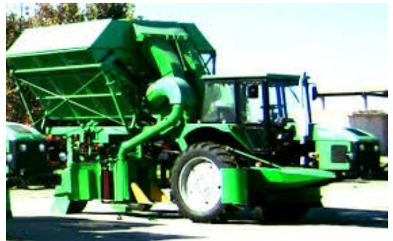
Şəkil 5.15. Pambıqyığan kombaynının sönmüş halında təmizlənməsi
