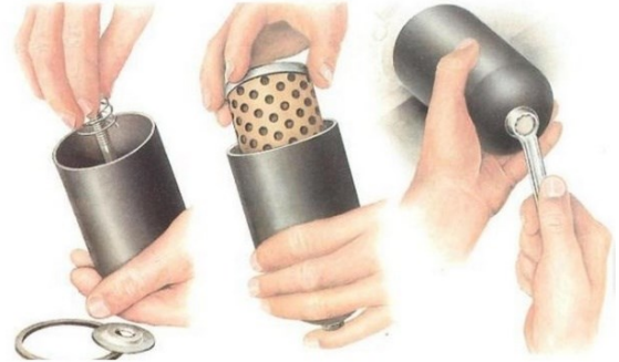
Şəkil 2.8. Hidravlik sistemdə yağ süzgecinin dəyişdirilməsi
