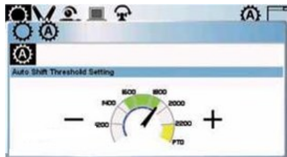
Şəkil 2.4. Mühərrikin cari tənzimləmə ekranının quruluşu
