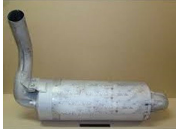
Şəkil 1.30. Aqreqatı işi zamanı yanğın törədən hissələr
