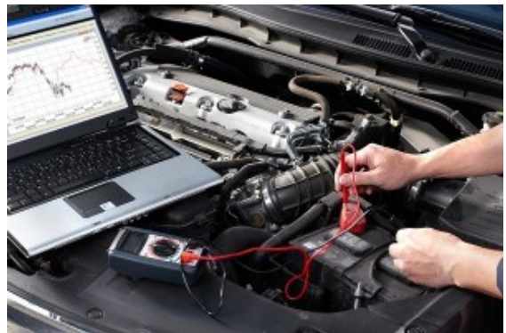
Şəkil 2.14. Starterin işə yararlılığının voltmetrlə yoxlanılması
