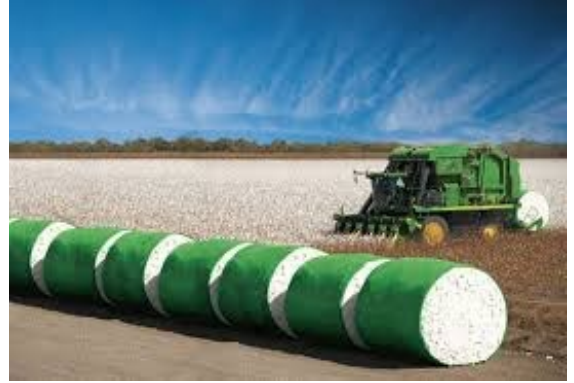
Şəkil 3.26. John Deere JD 690 markalı 6 cərgəli pambıqyığan kombaynla pambığın rulonlu kiplərlə toplanması
