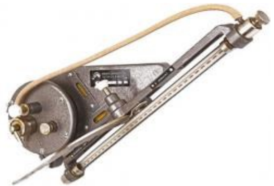
Şəkil 3.27. Kabinada yağın səviyyəsini ölçən mikromanometr
