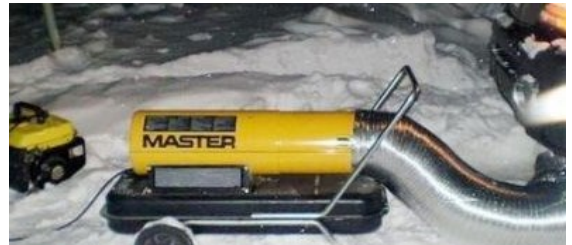
Şəkil 4.28. Şaxtada mühərrikin işə salınması zamanı istifadə edilən xüsusi qurğu
