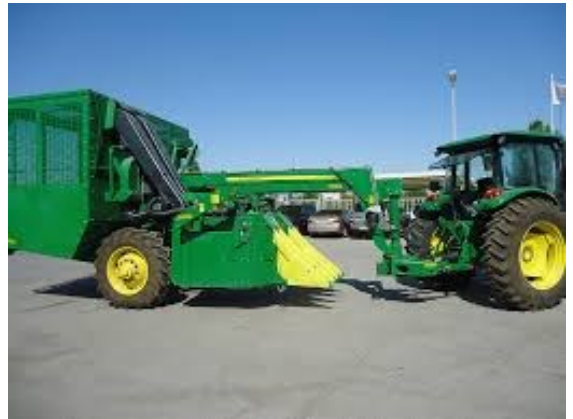
Şəkil 5.13. Qoşma pambıqyığan kombaynın tarlaya nəql etdirilməsi
