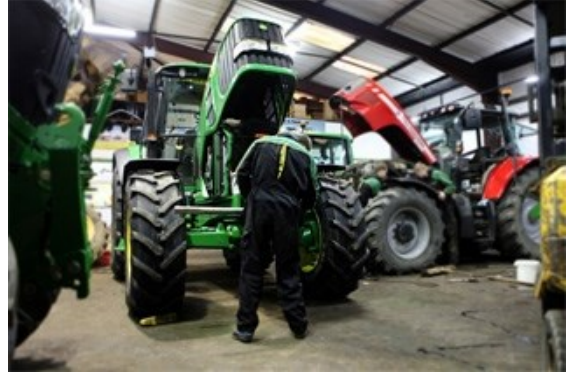
Şəkil 1.7. İşə başlamazdan əvvəl John Deere traktorunun mühərrikinə baxış keçirmə prosesi
