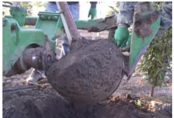
Şəkil 4.14. Texnikanın işçi orqanlarına torpağın yapışması
