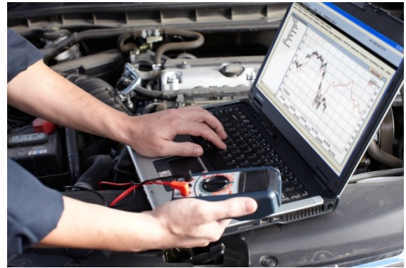
Şəkil 2.11. Traktorun elektrik avadanlıqlarının testerlə diaqnostika edilməsi və işə yararlığının yoxlanması
