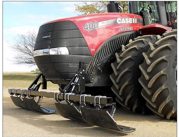
Şəkil 4.24. Case traktorunun təkərlərini bitki qalıqlarından qoruyan qurğu
