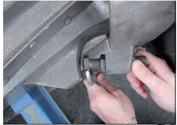
Şəkil 2.21. Traktorun dönmə hərəkətinin məhdudlaşdırıcısının tənzimlənməsi
