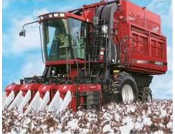
Şəkil 1.23. "Cotton Ekspress 420" pambıqyığan kombaynı ilə işin yerinə yetirilməsi
