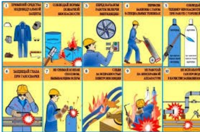
Şəkil 3.2. Aqreqatla iş zamanı təhlükəsizlik tədbirlərinin gözlənilməsi
