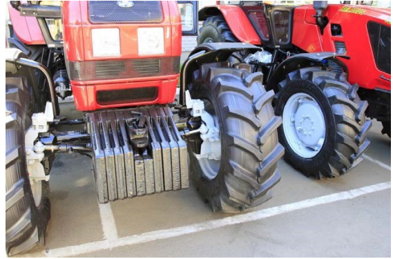
Şəkil 3.7. Belarus 1523 markalı traktora qoyulmuş əks yüklər
