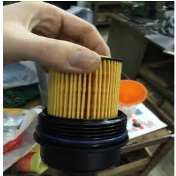
Şəkil 2.25. Dəyişdirilmiş süzücü elementinin yerinə qoyulması
