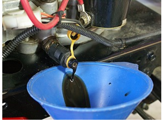
Şəkil 1.10. Yağın dəyişdirilməsi
