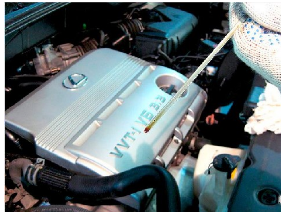
Şəkil 1.9. Mühərrikdə yağın səviyyəsinin yoxlanması
