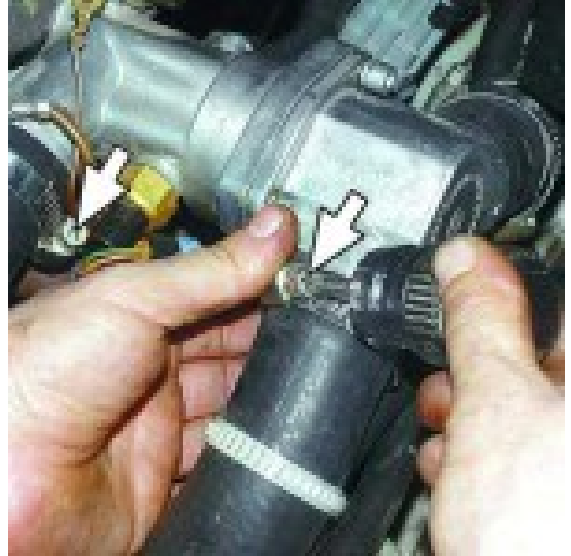
Şəkil 1.31. Soyutma sistemində ventillərin təmizlənməsi
