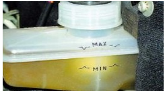
Şəkil 5.7. Əyləc sisteminin çənində mayenin səviyyəsinin yoxlanılması
