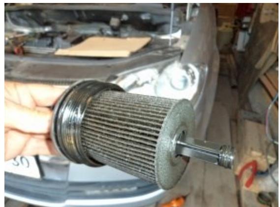
Şəkil 2.23. Sökülmüş süzğəcin yoxlanılması
