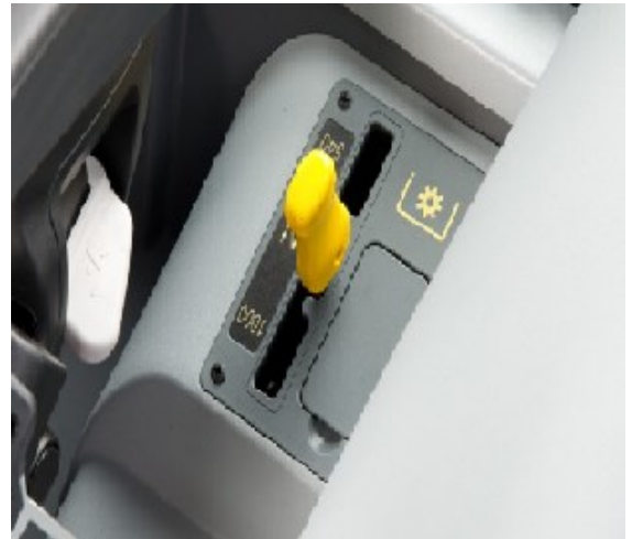
Şəkil 3.21. Daimi tezliklə fırlanan güc ayıran valın traktorun kabinasında birləşdirmə dəstəyi
