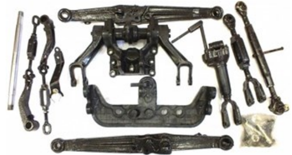
Şəkil 3.13. Asma mexanizminin əsas elementləri
