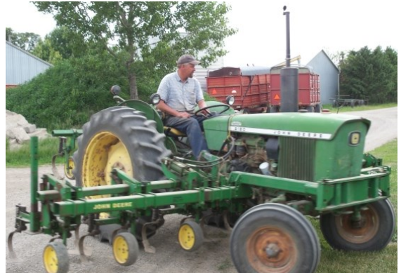
Şəkil 3.2. Maşının traktora öndən qoşulması
