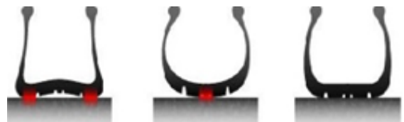
Şəkil 6.16. Hava təzyiqindən asılı olaraq şinlərin profili (1, 2, 3)
