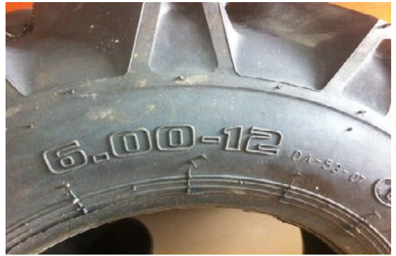
Şəkil 5.4. Şinin yan tərəfində göstərilən ölçülər
