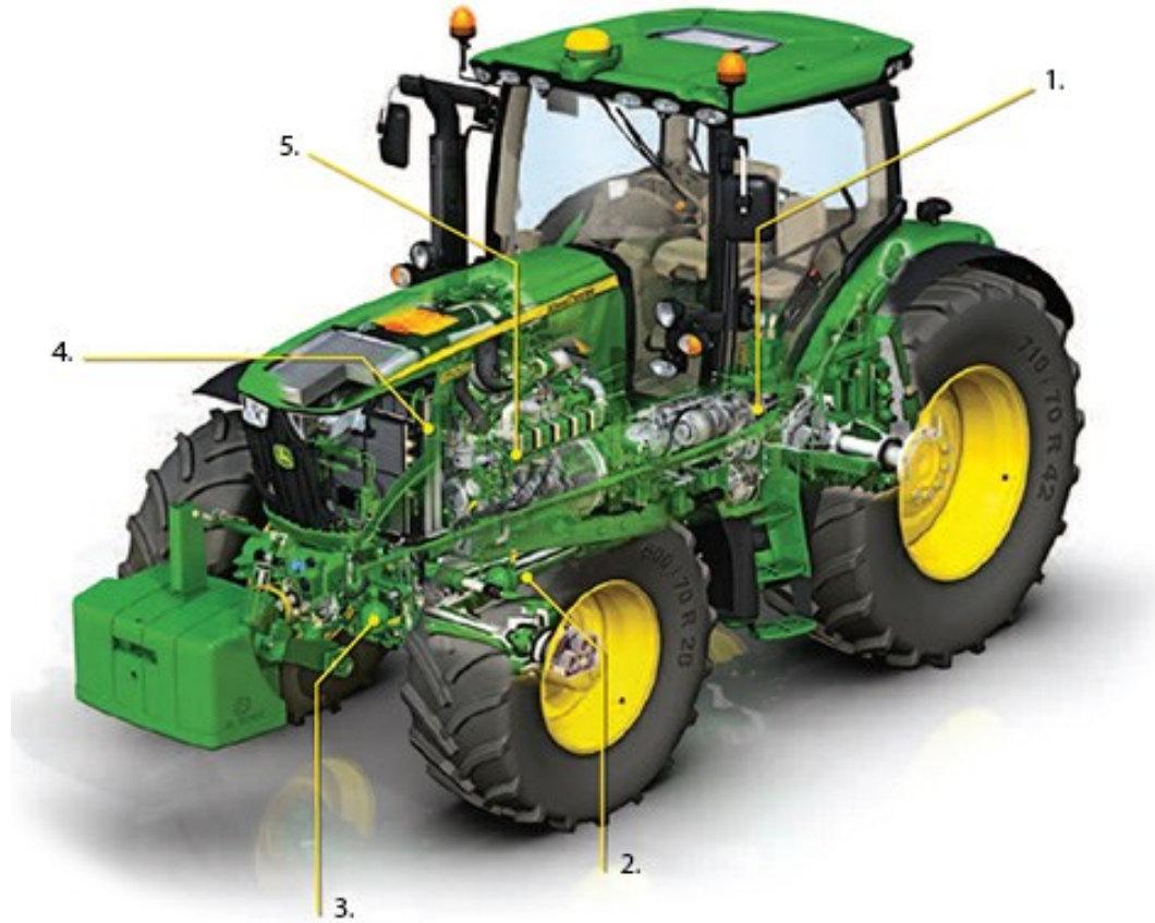
Şəkil 3.27. John Deere traktorlarında olan yağlama materialları, soyuducu maye və konsistent yağlar
