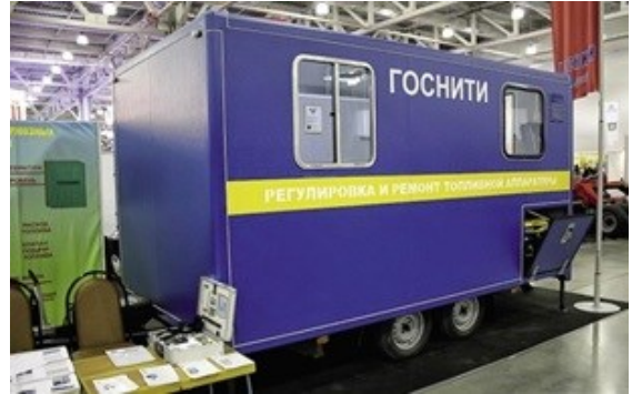
Şəkil 7.12. Diaqnostika və nizamlaşdırma işləri üçün qoşma laboratoriya
