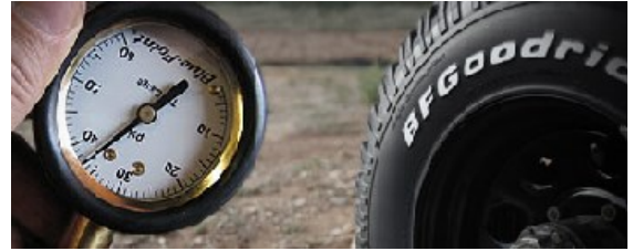
Şəkil 5.16. Şinlərdə havanın təzyiqinin manometrlə ölçülməsi
