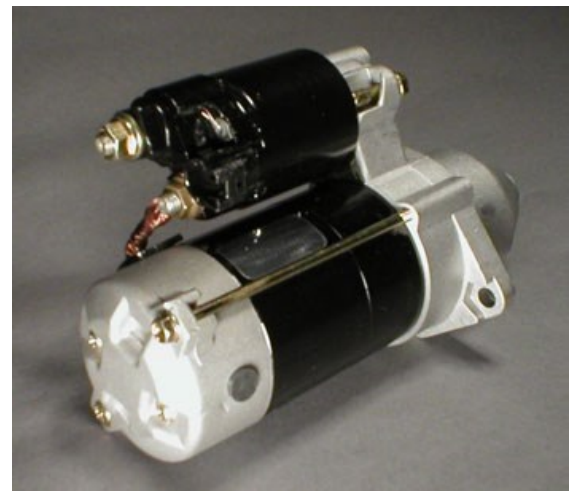
Şəkil 4.14. Elektrik starteri
