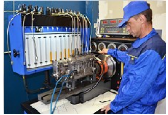
Şəkil 1.22. Yanacaq nasosunun stenddə nizamlanması
