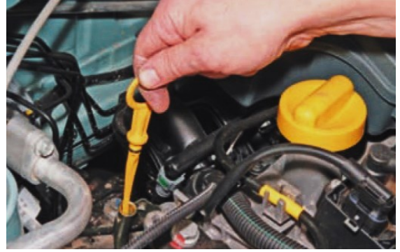
Şəkil 2.16. Hidrosistemin çənində yağın səviyyəsinin yoxlanması
