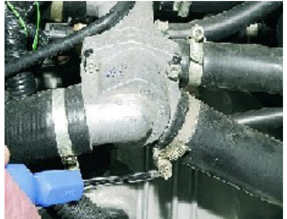
Şəkil 1.30. Soyutma sistemində qısa borular
