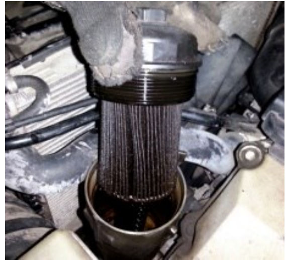
Şəkil 2.22. Süzücü elementin dəyişdirilməsi
