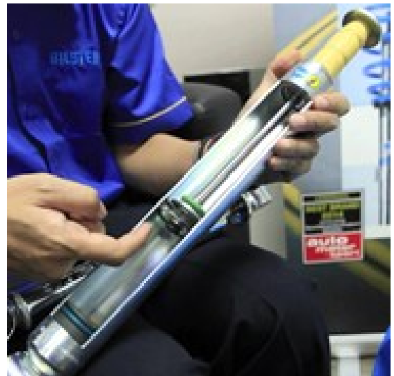
Şəkil 2.26. Qüvvə silindrinin işə yararlılığının yoxlanılması
