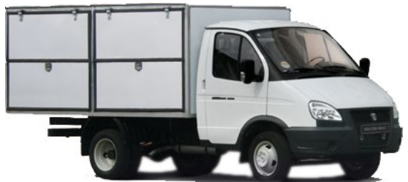
Şəkil 6.11. Tez xarab olan yemək məhsullarının daşınması üçün avtomobil
