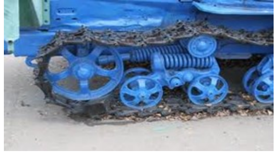
Şəkil 5.19. Tırtıllı traktorun yerləşli hissələri
