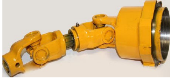
Şəkil 3.26. Kardan valında yağlama nöqtəsi
