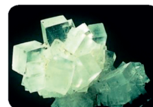
Каменная соль – основная руда натрия. Основным компонентом каменной соли является хлорид натрия.
