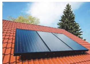
(а) Кремниевые солнечные батареи
