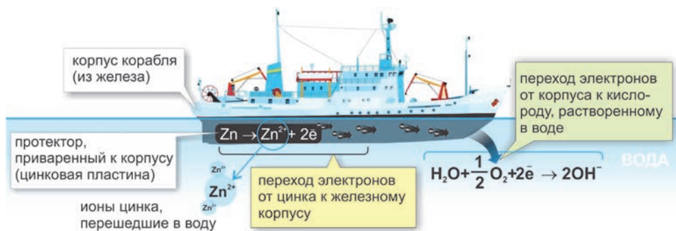
(d) Схема протекторной защиты корпуса корабля
