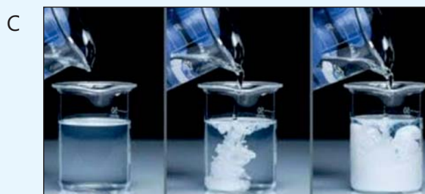
При добавлении раствора хлорида бария к раствору сульфата натрия образуются хлорид натрия и сульфат бария
