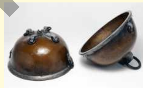
Магдебургские полушария, использованные для демонстрации атмосферного давления.
