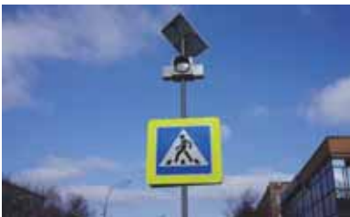
Günəş batareyası ilə işləyən piyada yol nişanı. Batareyalar gündüz saatlarında günəş enerjisini toplayaraq qaranlıq vaxtda ondan istifadə edir.
