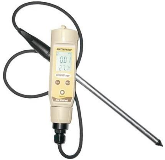
Şəkil 3.15. Substratın elektrik keçiriciliyini təyin etmək üçün konduktivit cihazı (EC-metr) FieldScout Direct Soil
