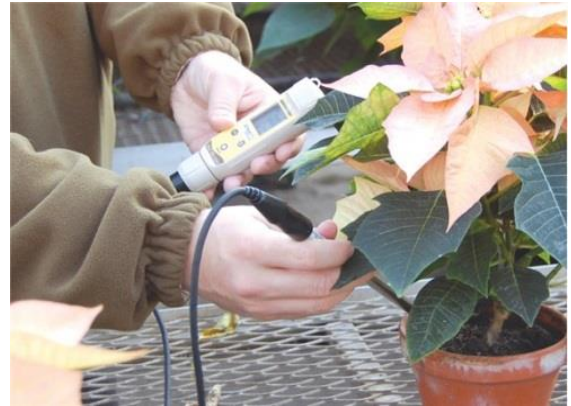
Şəkil 3.16. Substratın elektrik keçiriciliyini təyin etmək üçün FieldScout Direct Soil cihazı ilə işləmək qaydası
