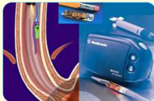
рН-радиокапсула "Браво" измеряет кислотность
