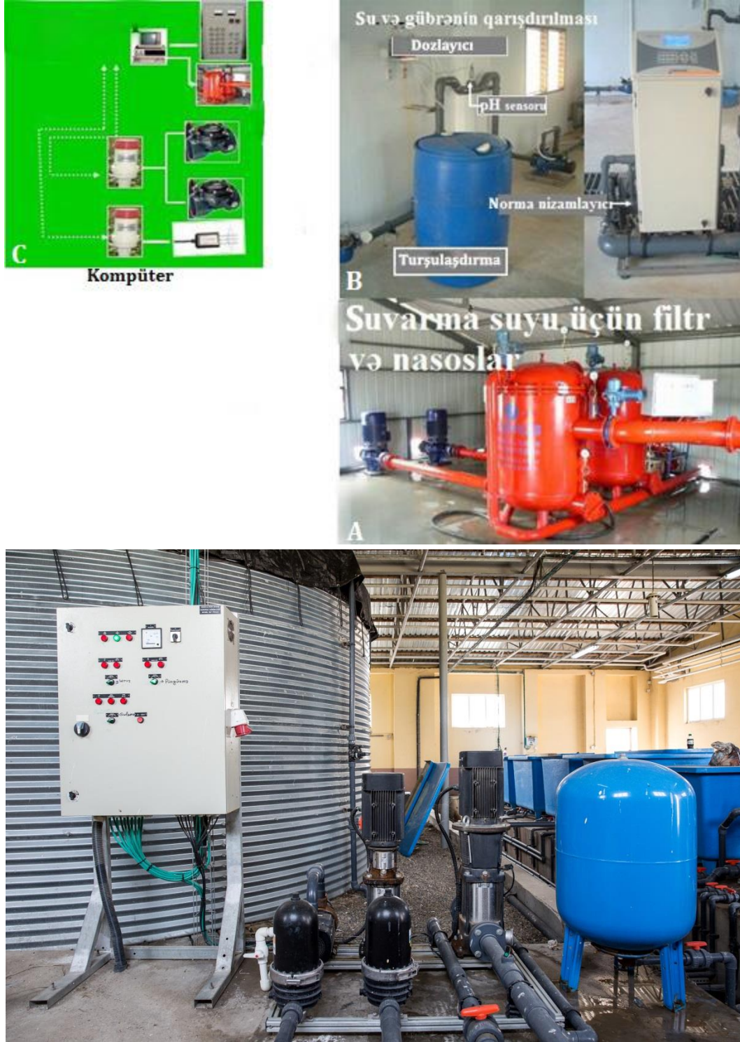
Şəkil 3.33. Avtomatlaşdırılmış gübrələmə və suvarma sisteminin iş prinsipi
