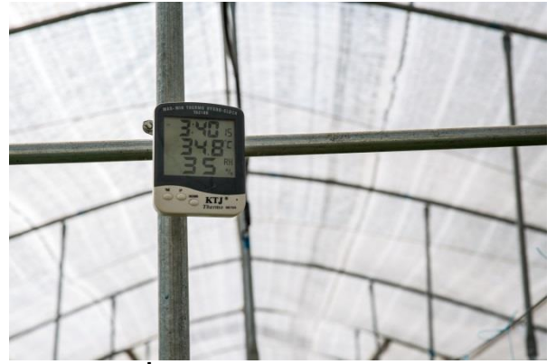
Şəkil 3.39. İstixanada havanın temperaturunu və rütubətini ölçən elektron cihaz
