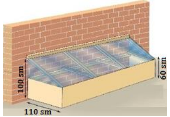
Şəkil 3.7. Yan tərəflərdən biri kərpic divar, qalan tərəfləri və üst hissəsi şəffaf materialdan örtük çəkilmiş parniklər
