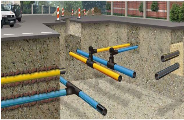
Şəkil 1.2. Qaz boru kəməri
