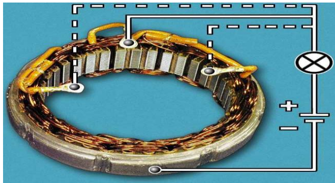
Şəkil 1.5. a; Statorun dolağında qırılma, kəsilmənin yoxlanması
