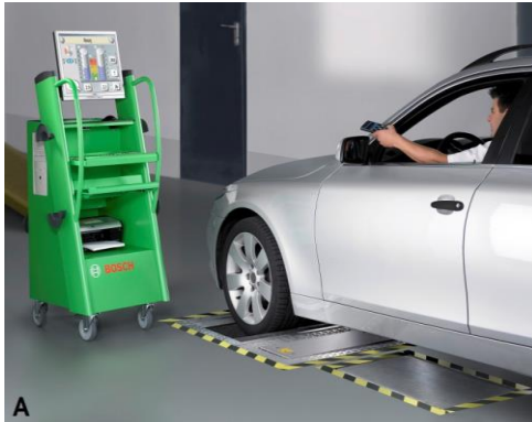
Şəkil 2.3. Minik avtomobilində tormoz sistemini yoxlayan stand (A) və alışdırma şamını yoxlayan cihaz(B)
