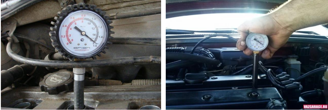
Şəkil 1.3. Mühərrikin silindrlərində kompressiyanın kompressometrlə ölçülməsi
