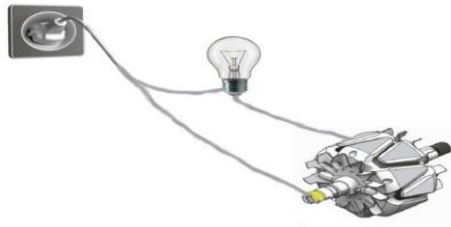
Şəkil 1.4. Rotor dolağında izolyasiyanın yoxlanması
