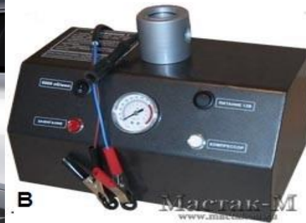
Şəkil 2.3. Minik avtomobilində tormoz sistemini yoxlayan stand (A) və alışdırma şamını yoxlayan cihaz(B)
