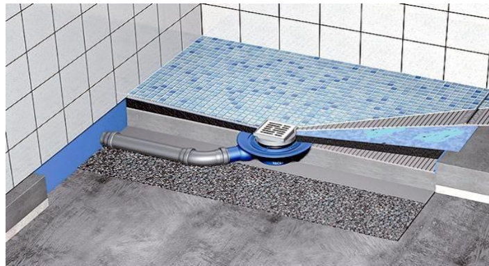
Şəkil 2.16. Trapın kanalizasiya borusuna birləşdirilməsi
