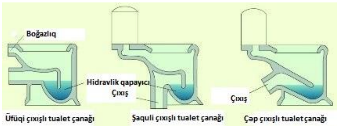
Şəkil 3.12. Tualet çanaqlarının çıxış formaları
