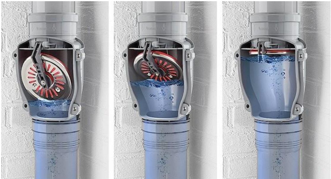
Şəkil 1.32. Kanalizasiya ventilyasiyası klapni
