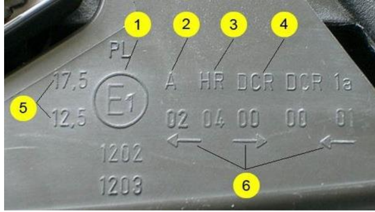
Şəkil 4.10 1 – ölkənin kodu (E1 – Almaniya, E2 – Fransa və s.); 2 – faraların təyinatı (A – yan faralar, C – yaxın və s.); 3 – H4 halogen lampaların reqlamenti (HC – halogen lampalı yaxın, HR – halogen lampalı uzaq işıq və s.); 4 – ksenon lampalar üçün faraların markaları (DR – ksenon uzaq, DC – ksenon yaxın və s.); 5 – işıqlandırma dərəcələri: Lyukslar – 7,5; 10; 12,5; 17,5; 20; 25; 27,5; 30; 37,5; 40; 45; 50; 6 – hərəkət istiqaməti
