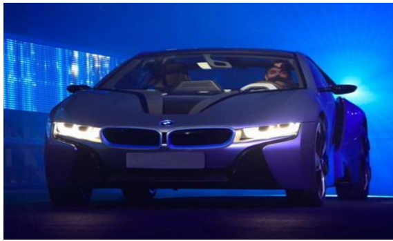
Şəkil 1.1 e. Lazerli matriç faralar – lazer modullu
