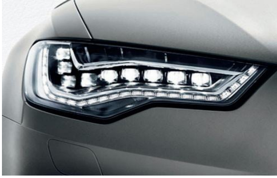
Şəkil 1.1 d. Matriç faralar – yaxın və uzaq işıqlar üçün 15 və 25 işıqdioddan təşkil olunmuş işıq modulu.
