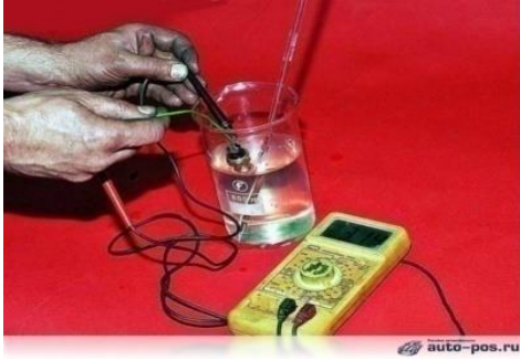
Şəkil 3.6 Vericinin multimetrlə yoxlanılması
