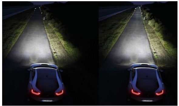
Şəkil 1.1 e. Lazerli matriç faralar – lazer modullu
