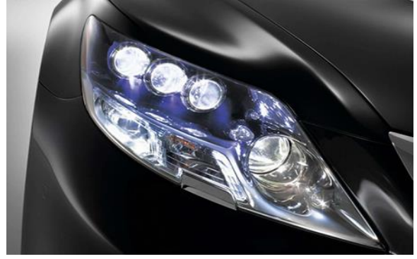
Şəkil 1.1 d. Matriç faralar – yaxın və uzaq işıqlar üçün 15 və 25 işıqdioddan təşkil olunmuş işıq modulu.
