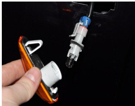
Şəkil 4.5 Dönmə işıq göstəricisinin volframlı közərmə lampası
