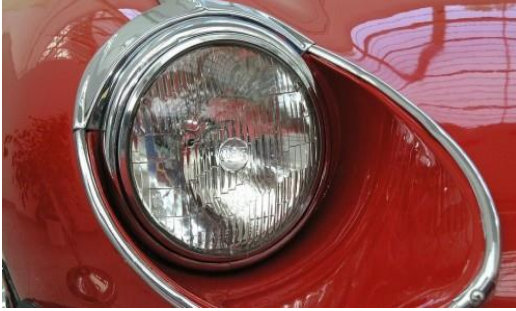
Şəkil 1.1 a. Klassik faralar – közərmə lampaları (adətən, ikitelli)
