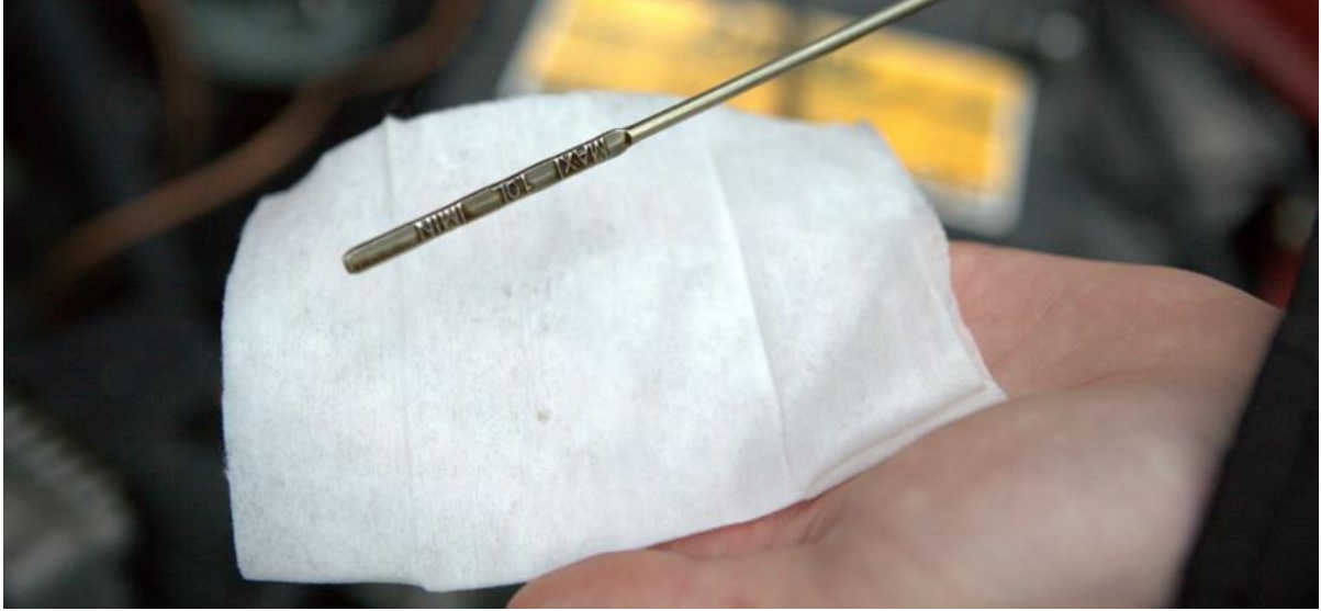
Şəkil 3.10 Yağın səviyyəsini ölçmək üçün ölçü mili
