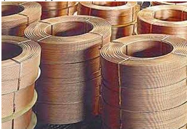
Şəkil 2.2. Nicrofer 4221 - ərinti 825 (XH38BT) - mis və molibden, nikel-dəmir xəlitəli xrom
