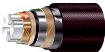
CB və ACБ – uyğun olaraq mis və alüminium damarlı, kağız izolyasiyalı, qurğuşun örtüklü, lentşəkilli polad zirehli və xarici mühafizə örtüyü lifli materialdan olan güc kabelləri
