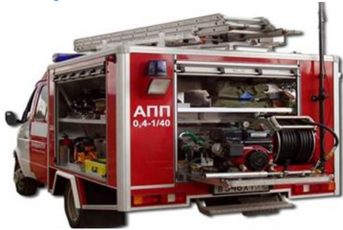
Şəkil 1.5. Yanğınsöndürmə alat və avadanlığının maşında yerləşdirilməsi.
