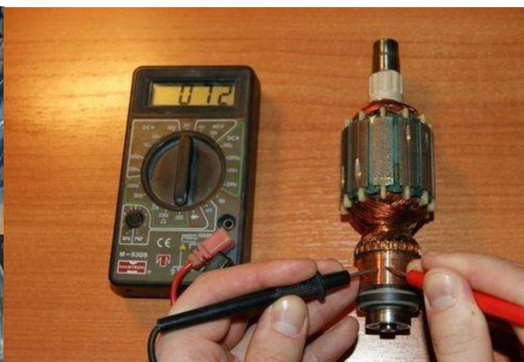
Şəkil 3.19. Lövbərin müqavimətinin ölçülməsi
