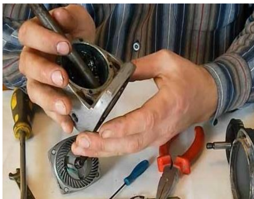
Şəkil 3.18. Bolqarkanın təmiri
