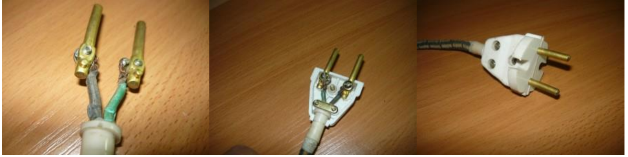
Şəkil 3.12. Elektrik çəngəlinin quraşdırılması mərhələsi
