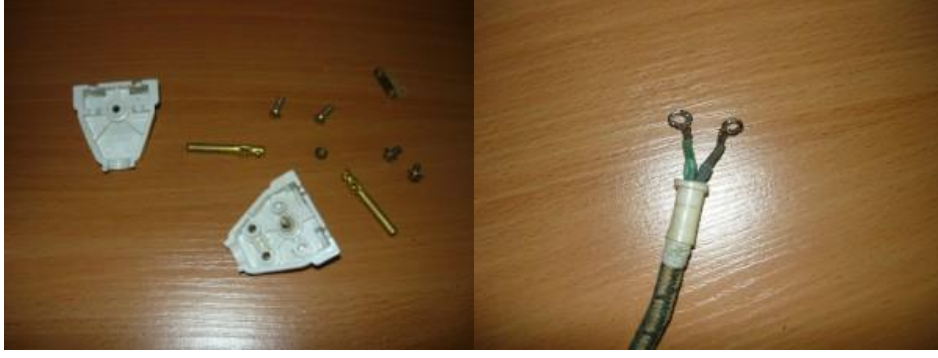
Şəkil 3.11. Elektrik çəngəlinin sökülməsi və naqilin uc hissəsinin hazırlanması
