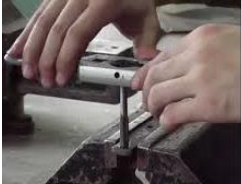
Şəkil 3.6 Daxili yivəçənin burucu-tutucusu
