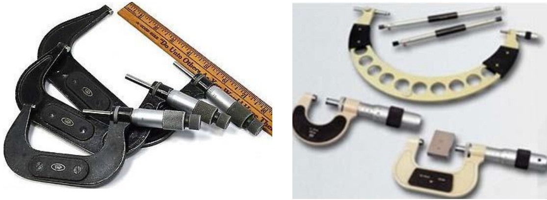
Şəkil 2.6 Müxtəlif ölçü həddü mikrometrlər
