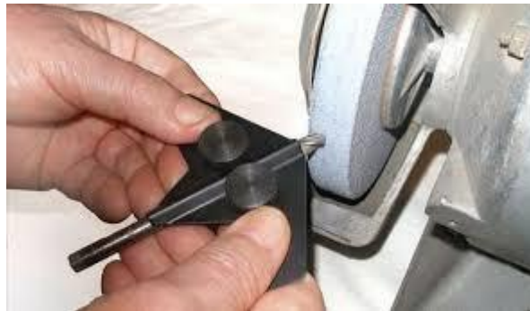
Şəkil 2.26 Burğuların itilənməsi
