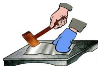
Şəkil 2.19 Metal səthin dəldilməsi
