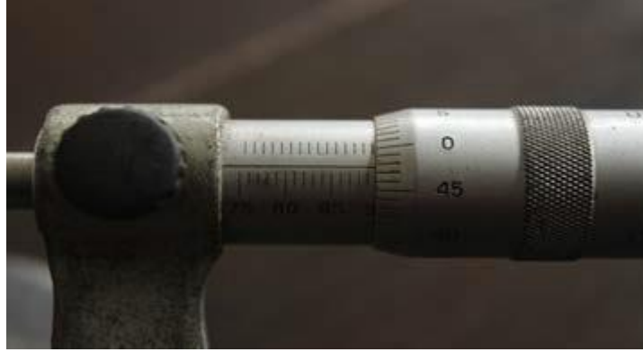
Şəkil 2.5 Mikrometrlə ölçmə
