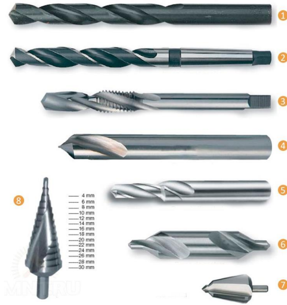
Şəkil 2.25 Müxtəlif konstruksiyalı burğular
