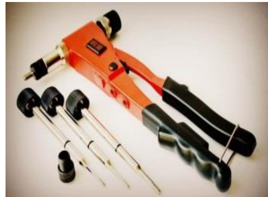
Şəkil 3.13 Əllə işlədilən pərçimləyici
