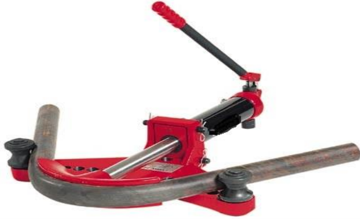
Şəkil 3.2 Metal borunun yarımdairəvi əyilməsi
