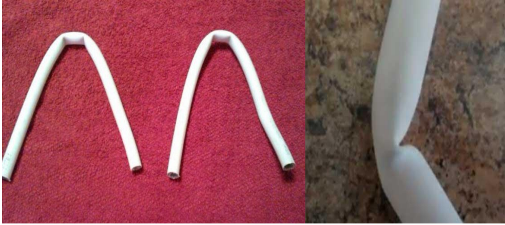
Şəkil 3.10 Əyilərkən zədələnmiş metalloplastik borular
