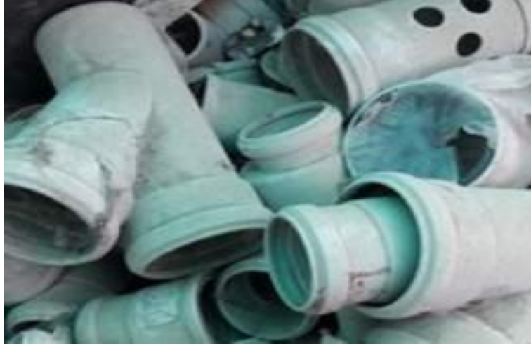
Şəkil 2.24 Zədələnmiş polietilen kanalizasiya boruları
