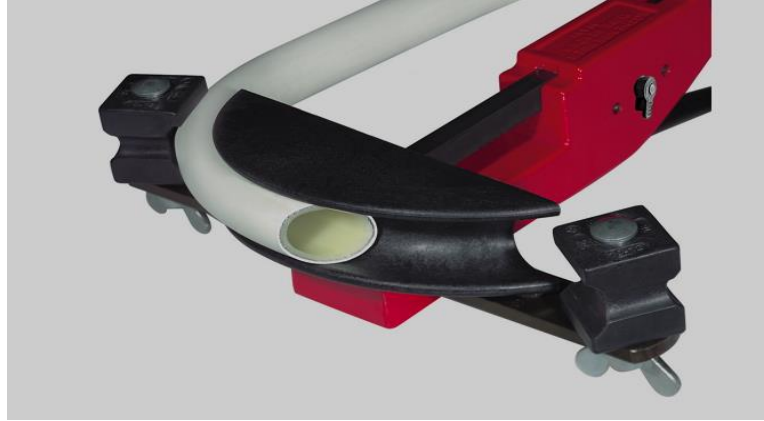
Şəkil 3.12 Metalloplastik borunun boruəyən vasitəsilə əyilməsi
