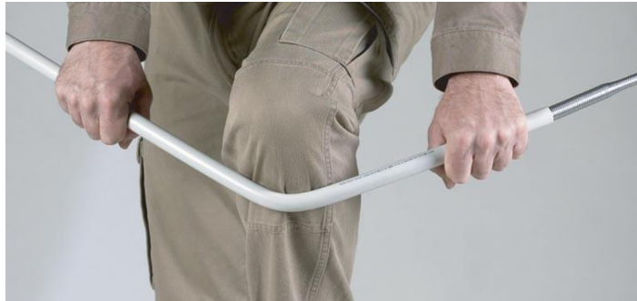
Şəkil 3.9 Metalloplastik borunun əyilməsi
