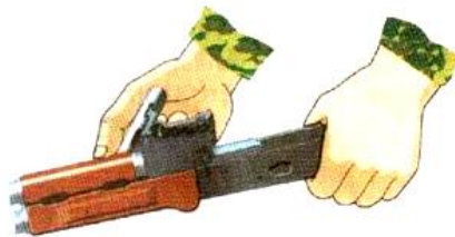
Şəkil 2.35. Qaz borucuğunun lülə üstlüyünün çıxarılması
