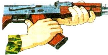
Şəkil 2.32. Qaytarıcı mexanizmin çıxarılması
