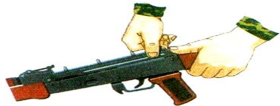
Şəkil2.28. Darağın çıxarılması
