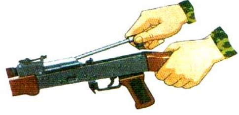
Şəkil 2.29. Penalın qundaqdakı yuvaya yerləşdirilməsi
