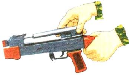
Şəkil 2.33. Çaxmaq çərçivəsinin çaxmaqla birlikdə çıxarılması
