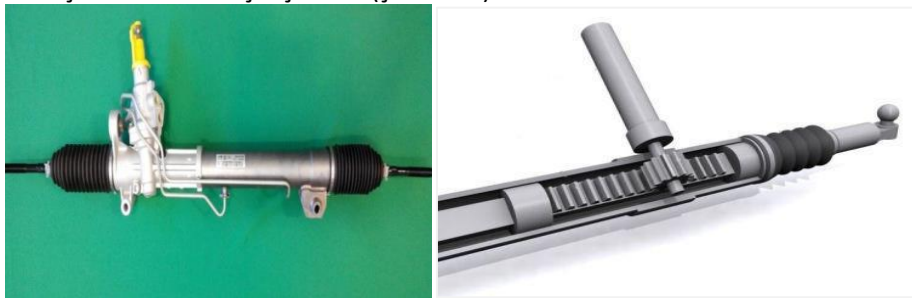
Şəkil 3.6. Dişli çarx-tamasa sükan mexanizmi
