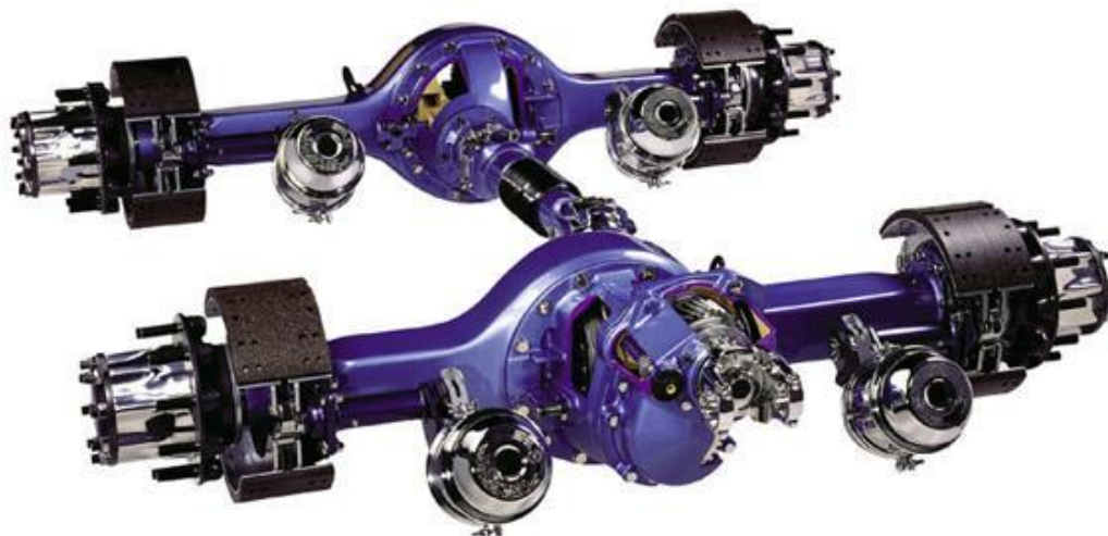
Şəkil 5.14. Sökülməyən ştamplanmış - qaynaq olunmuş aparən körpü
