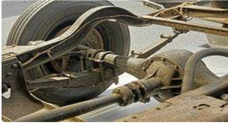
Şəkil 5.13. Yük avtomobilinin sökülməyən arxa körpüsü
