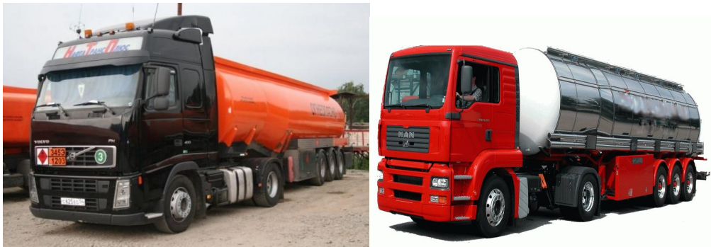
Şəkil 4.3 .Yük kuzovları – sistənlə avtomobillər
