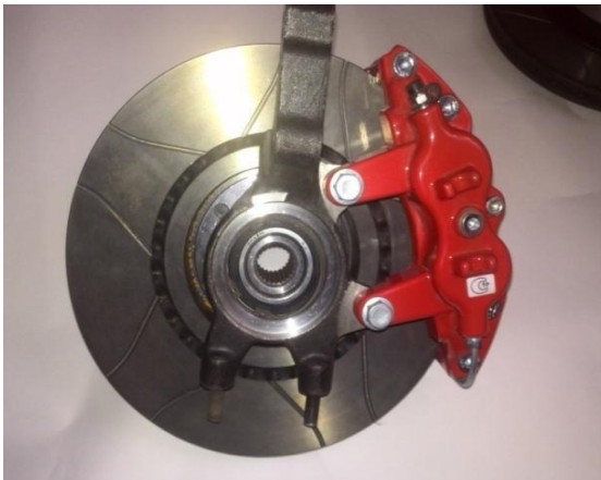
Şəkil 3.10. Bir tərəfli təsirli və iki tərəfli təsirli porşenli əyləc mexanizmi
