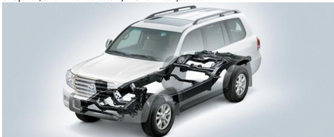
Şəkil 5.2. Çərçivəli aparan sistem
