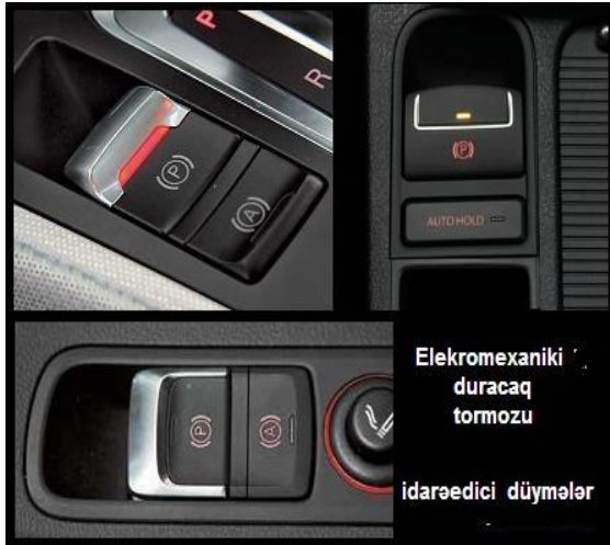
Şəkil 3.23. Elektron duracaq əyləci: a – sürücü tərəfindən idarəediciləri panel; b – supportda qurulmuş elektron duracaq;
