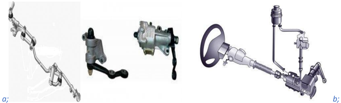
Şəkil 3.2. Sükan mexanizmləri: gücləndiricisiz (a) və gücləndirici ilə (b);
