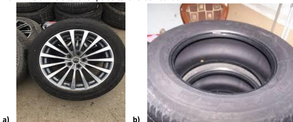
Şəkil 5.16 Diskli (a) və disksiz (b) təkərlər
