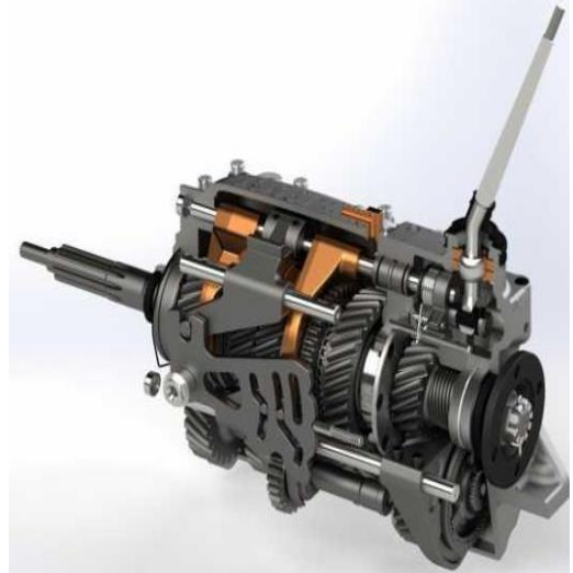
Şəkil 2.4 Mexaniki ötürmə qutusu
