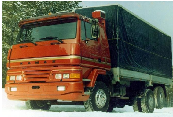
Şəkil 4.8. Kabinəsi kapotsuz yük avtomobilləri
