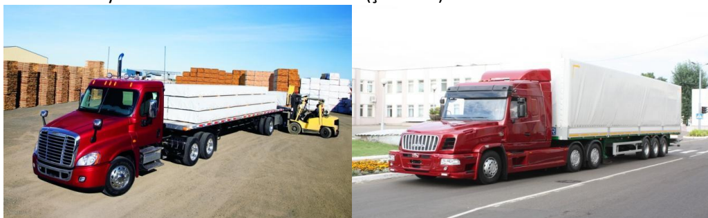
Şəkil 4.7. Kabinəsi kapotlu yük avtomobilləri
