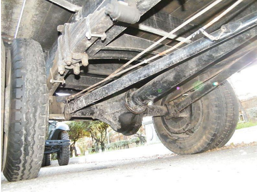
Şəkil 5.15. Yük avtomobilin arxa aparılan körpüsü
