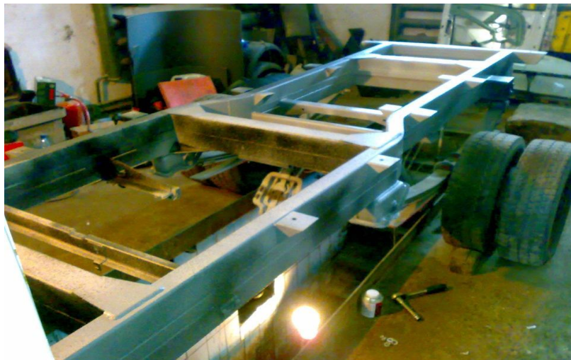
Şəkil 5.4. Lonjeronlu yük avtomobilinin çərçivəsi
