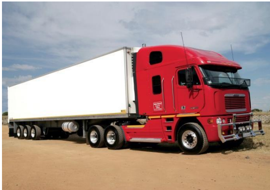
Şəkil 4.8. Kabinəsi kapotsuz yük avtomobilləri
