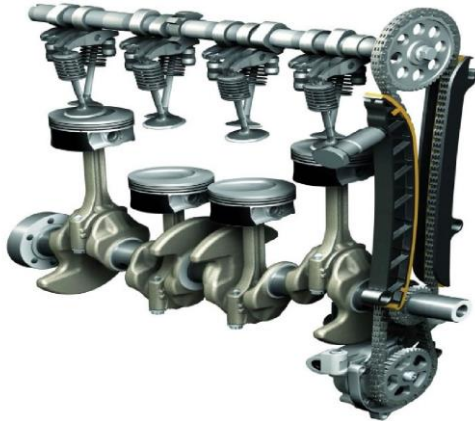
Şəkil 1.9. Qazpaylama mexanizmi
