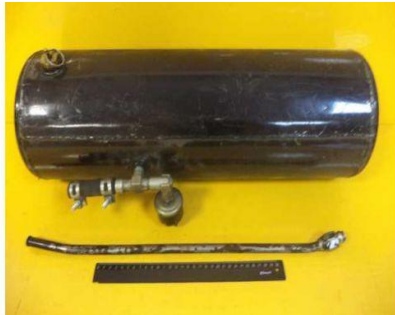
Şəkil 3.18. Pnevmatik əyləclərin hava ehtiyatı balonu
