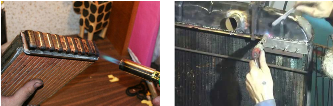
Şəkil 4.13 Radiatorun lehimlənməsi
