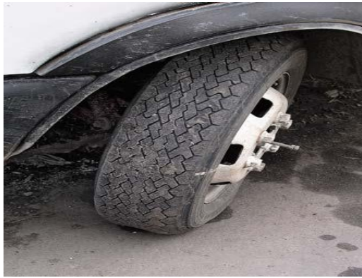
Şəkil 3.1 Manevr zamanı təkərin yeyilməsi
