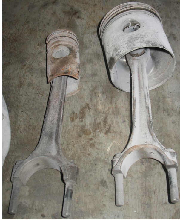
Şəkil 3.9 Yeyilmiş porşen qrupu və sürgüqolu
