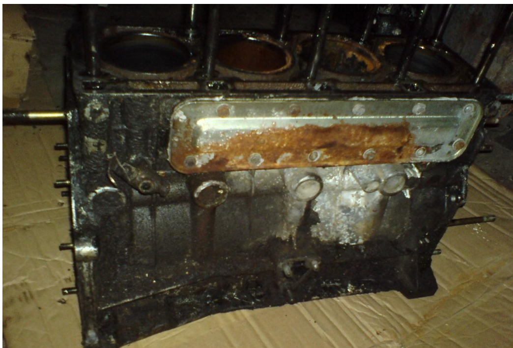
Şəkil 3.12 Korroziyaya uğramış mühərrik
