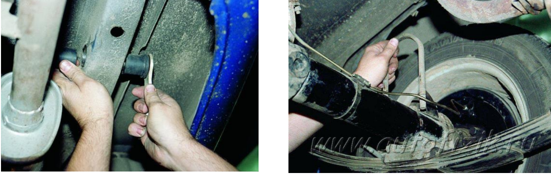
Şəkil 4.10 Ressor və resor barmağının dəyişdirilməsi
