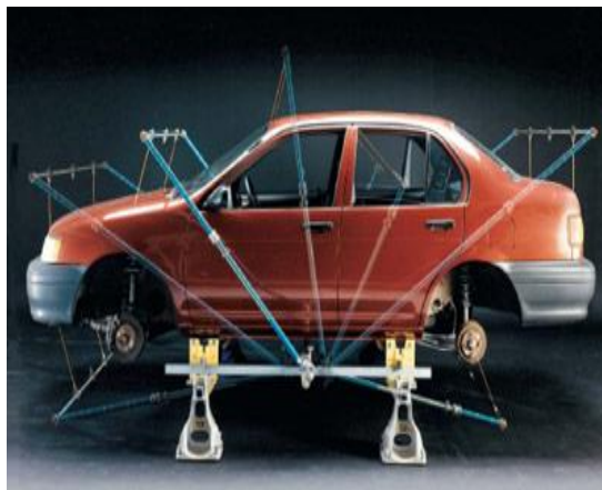
Şəkil 3.16. Simmetriya prinsipli həndəsi ölçmə sistemi
