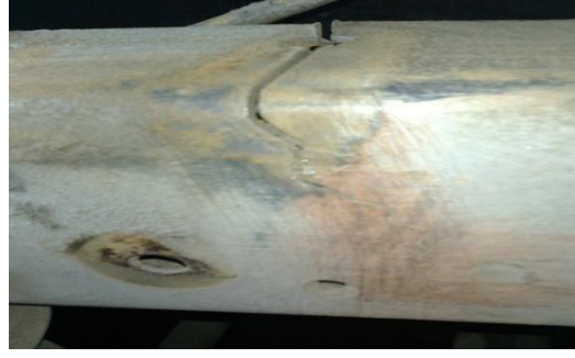
Şəkil 2.38. Yük avtomobili çərçivəsində yaranmış çatlar
