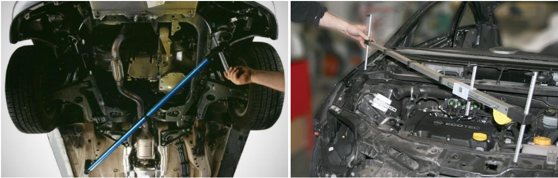
Şəkil 3.19. Kuzov altında və mühərrik bölməsində xətkəşlə ölçmə
