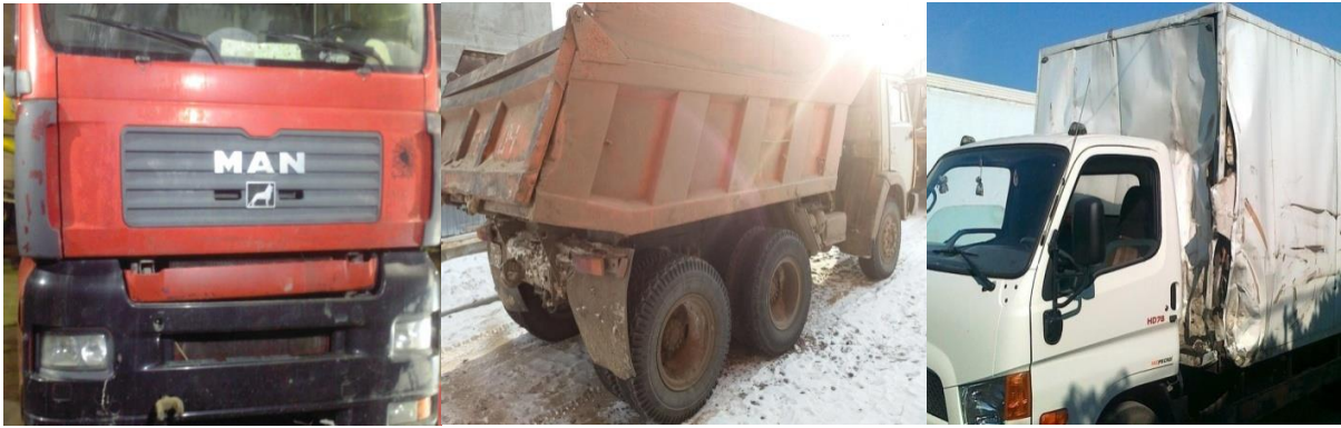
Şəkil 2.43. İstismar və qəza zamanı kuzov və kabinələrdə deformasiyalar
