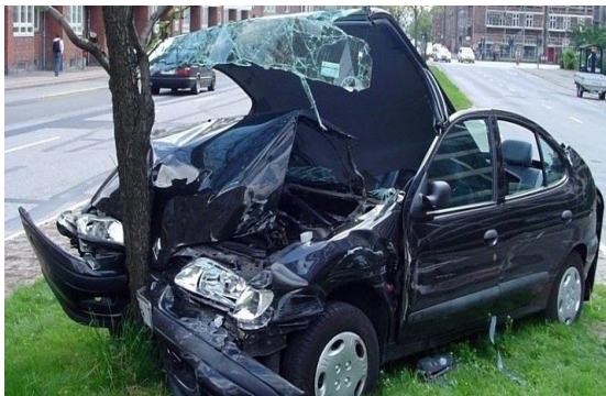
Şəkil 2.24. Qalıcı (daimi) maneə ilə toqquşma
