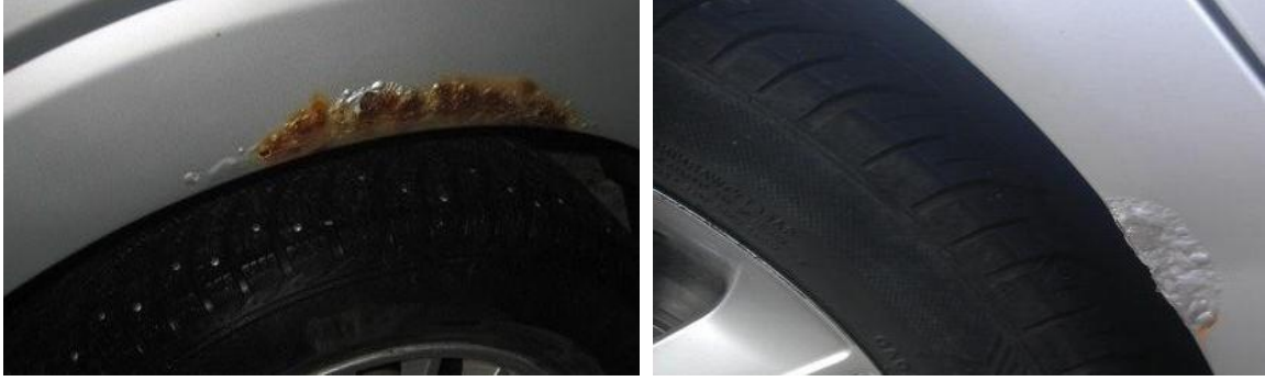
Şəkil 2.49. Kuzov elementinin korroziyası
