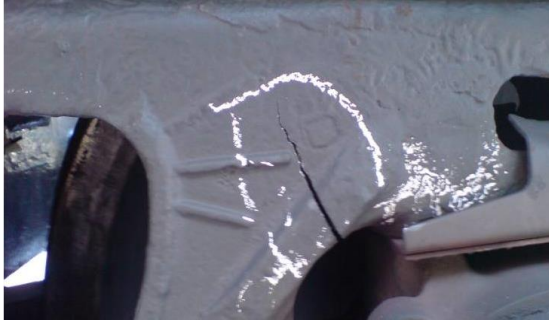
Şəkil 2.38. Yük avtomobili çərçivəsində yaranmış çatlar
