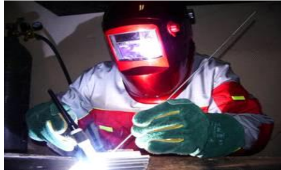
Sxem 2.4. və Şəkil 2. 9. Arqon-qövslü qaynaq: 1 -əsas metal; 2 -qatqı çubuğu; 3 -volfram elektrod; 4- müşdük; 5 -təsirsiz qaz örtüyü; 6 -elektrik qövsü; 7 -ərimiş metal
