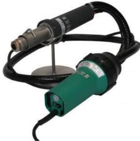
Şəkil 1.6. Plastik hissələrin təmirində istifadə olunan termoplastik qaynaq avadanlığı
