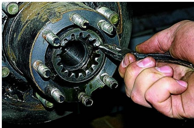
Şəkil 3.16 Arxa təkər topunun yatağının nizamlanması
