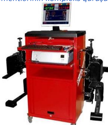
Şəkil 6.3 Sükan mexanizminin sınağını aparmaq üçün stend
