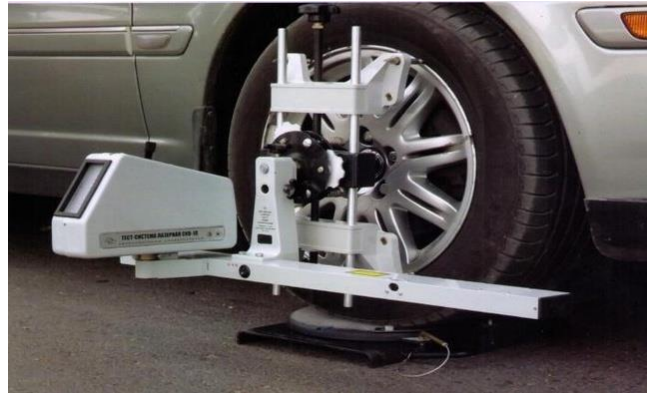
Şəkil 3.13 Qabaq təkərlərin qurulma bucaqlarını ölçən lazer stend CKO-17
