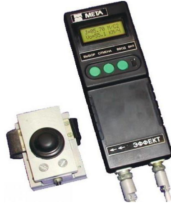
Şəkil 2.15 Əyləc sisteminin effektivliyini yoxlayan cihaz
