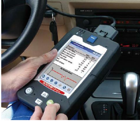
Şəkil 2.14 Elektron idarə sistemli avtomobillərdə diaqnostika aparmaq üçün skaner
