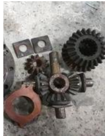
Şəkil 4.13 Differensial çarpazı və satellitləri
