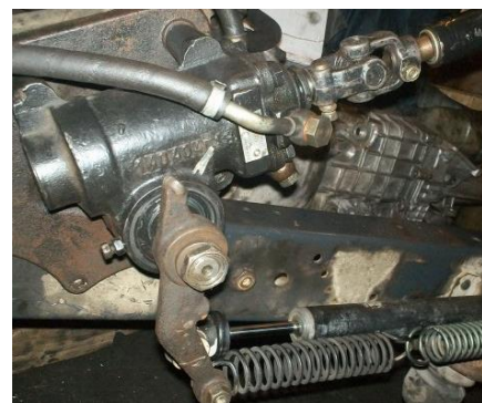
Şəkil 6.4 Hidrogücləndiricisi olan sükan mexanizminin sökülmesi
