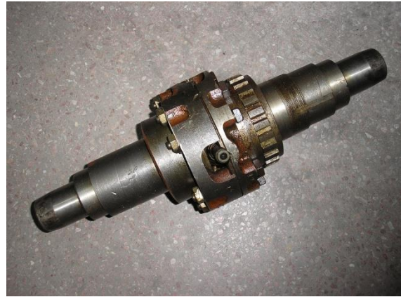
Şəkil 4.12 Differensial qutusu yığılmış halda
