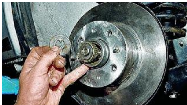
Şəkil 3.15 Qabaq təkər topunun yatağının yoxlanılması və nizamlanması
