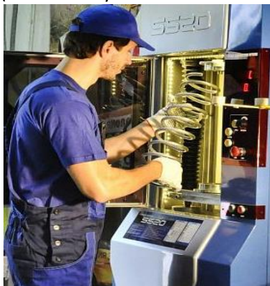
Şəkil 5.14 Yayların diaqnostikasının aparıldığı avadanlıq SS20
