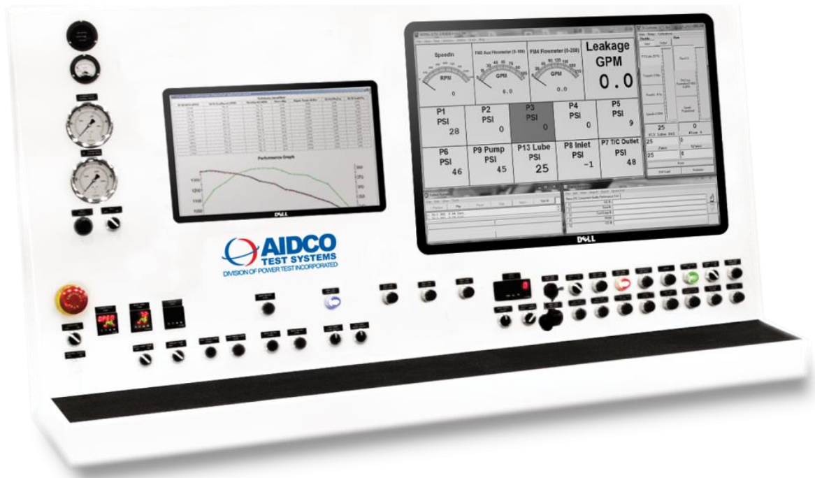
Şəkil 4.3 Transmissiya elementlərinin sınaq stendi AIDCO 850/900 əməliyyat nəticələrinə nəzarət lövhəsi
