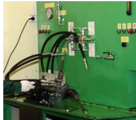
Şəkil 6.11 Sükan dartqısının təmiri
