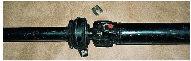
Şəkil 4.9 Kardan ötürməsinin sökülməsi
