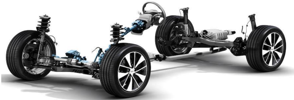
Şəkil 2.2 Minik avtomobili şassisinin tərkibini təşkil edən mexanizm və düyünlər
