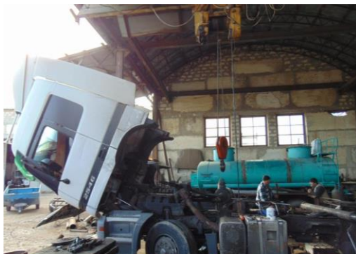
Şəkil 1.2 Yük avtomobilinin əsas hissələrə sökülməsi
