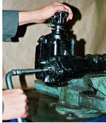
Şəkil 3.21 Sükan intiqalının nizamlanması
