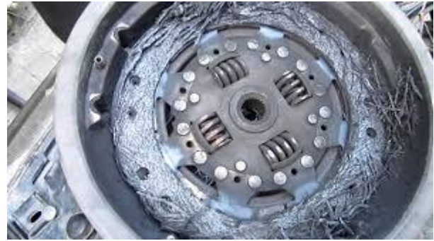
Şəkil 4.4 Aparılan diskin yeyilməsi
