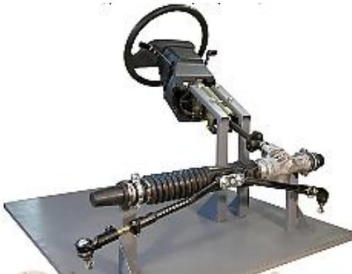
Şəkil 6.1 Sükan idarəsinin sökülmesini və yığılmasını öyrənmək üçün onun elementlərinin kompleks quraşdırıldığı
