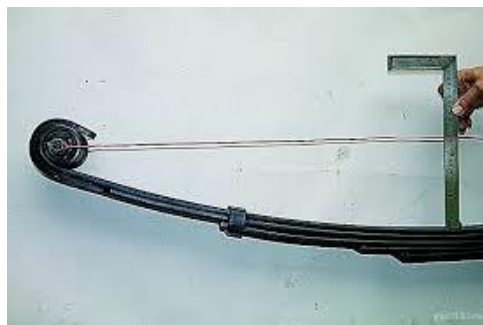
Şəkil 5.12 Ressorların əyilmə oxunun yoxlanılması
