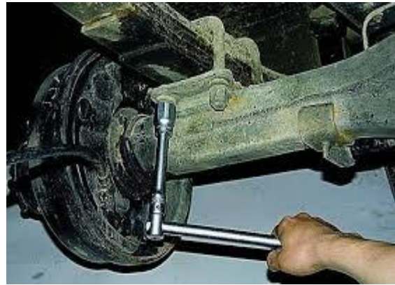
Şəkil 5.5 Asqıların avtomobilin körpüsündən və çərçivəsindən ayrılması
