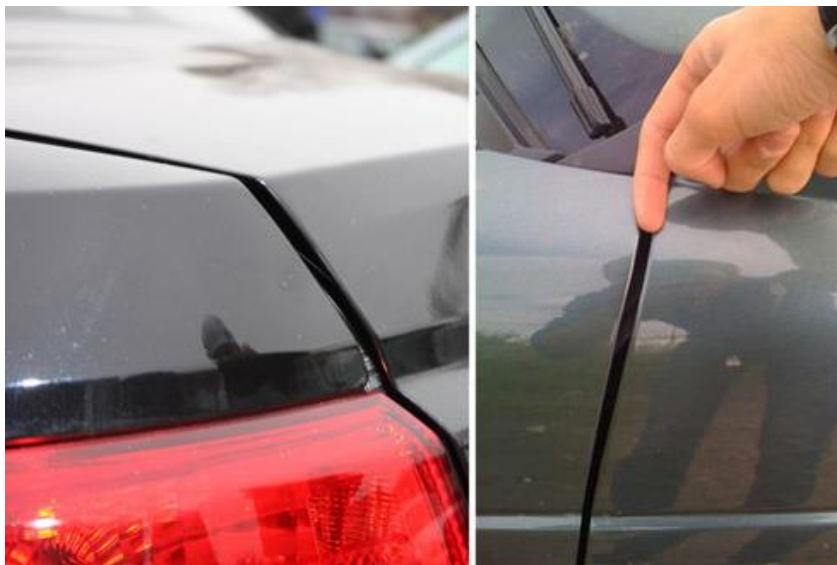
Şəkil 3.14. Yük bölməsində yaranmış araboşluqlar
