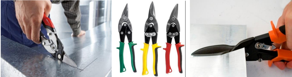
Şəkil 1.14. Metal vərəqlərin kəsilməsi və kəsmə alətləri
