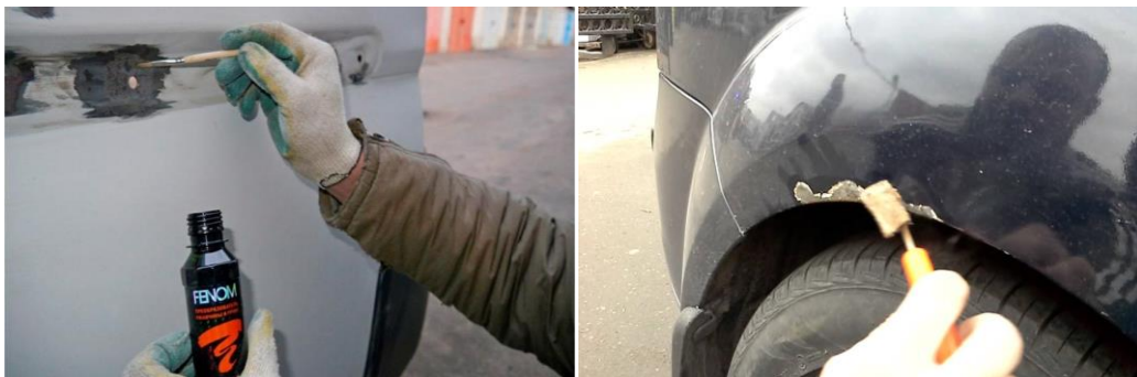
Şəkil 2.31. Pasların kimyəvi üsulla təmizlənməsi
