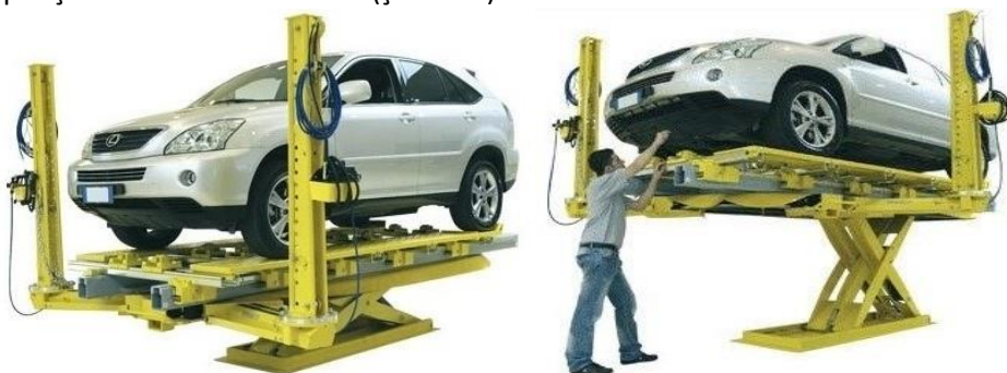
Şəkil 3.9. Platformalı, qaldırıcı və kolonlu SPENSİ "PİSTA" stapeli
