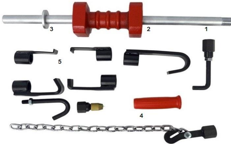
Şəkil 2.25. Kuzov təmirində istifadə edilən zərbə tipli alət və dəsti 1 – mil; 2 – çəkic; 3 – dirənmə şaybası; 4 – dəstək; 5 – ucluqlar
