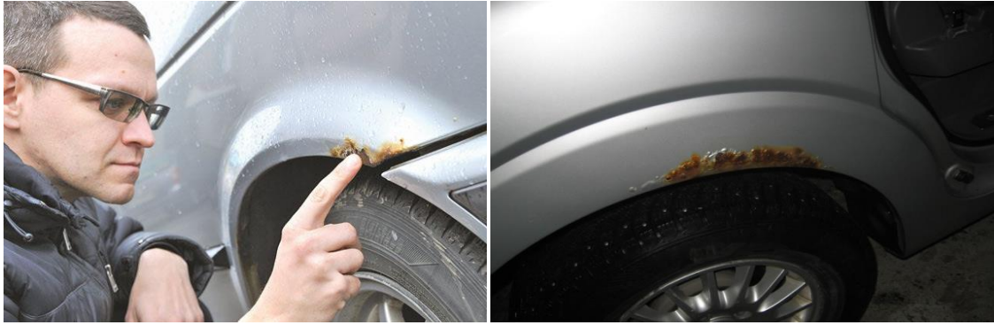
Şəkil 2.28. Korroziyaya uğramış hissələr
