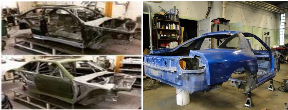
Şəkil 2.4. Təmir üçün kuzovun dayaqalarda qurulması
