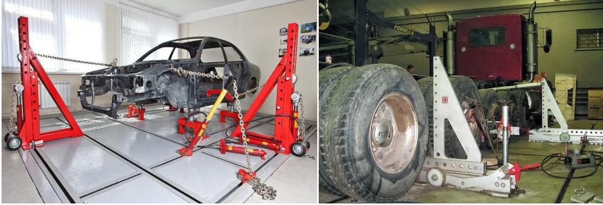
Şəkil 3.4. Minik avtomobil kuzovunda düzəlmə Şəkil 3.5. Yük avtomobili çərçivəsində işləri üçün istifadə olunan hərəkətli güc qurğusu düzəlmə işi üçün hərəkətli güc qurğusu
