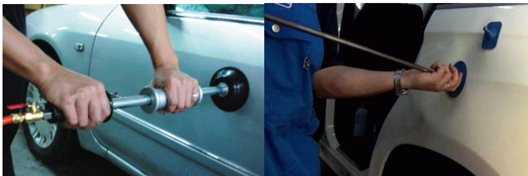
Şəkil 2.12. Vakuum tərtibatla batıqların(çalaların) bərpası
