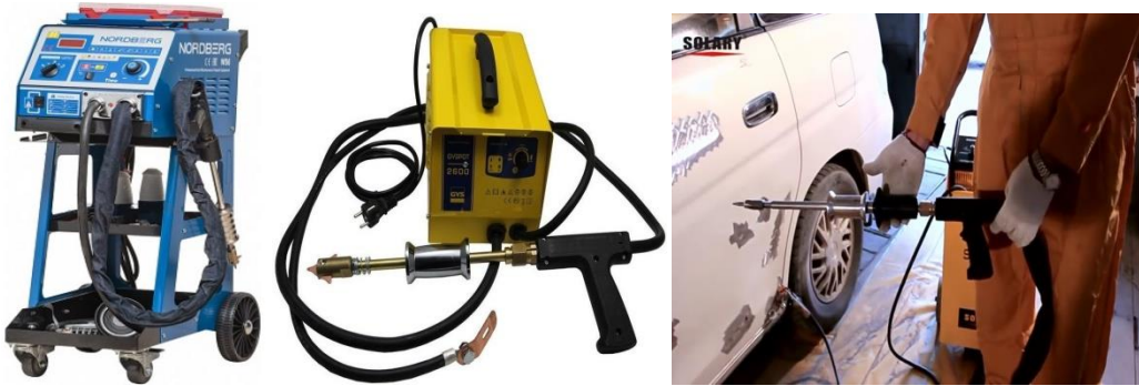
Şəkil 2.26. Kuzov panellərinin təmirində istifadə edilən spotterlər
