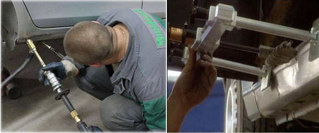
Şəkil 2.27. Spotter və dartıcı tərtibat ilə ayaqaltıdan batıqların bərpası
