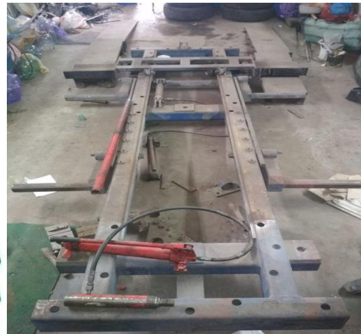
Şəkil 3.1. Hidravlik gərilmə (hidrosilindr) və ucluqları
