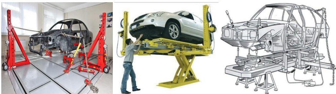
Şəkil 3.7. Deformasiyanı aradan qaldırmaq üçün stasionar, hərəkətli və güc qurğulu stendlər
