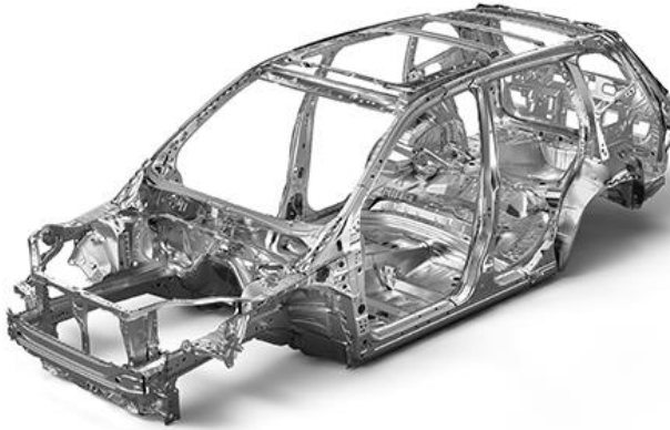
Şəkil 1.1. Polad məhsulları: sökülməyən minik avtomobilinin gövdəsi və təkər disk
