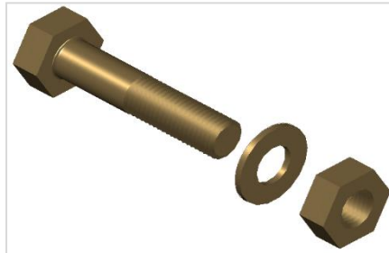
Şəkil 2.23. Bolt birləşməsi. Bolt birləşməsinin tərkibinə daxil olan hissələr - bolt, qayka və şayba
