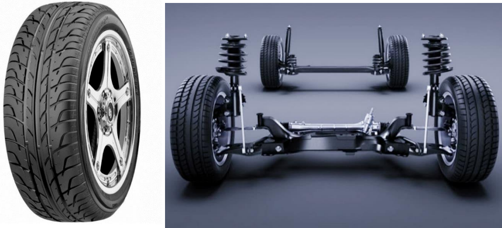
Şəkil 1.2. Metal (polad) və qeyri metaldan (rezin) ibarət: təkər və asqı sistemi
