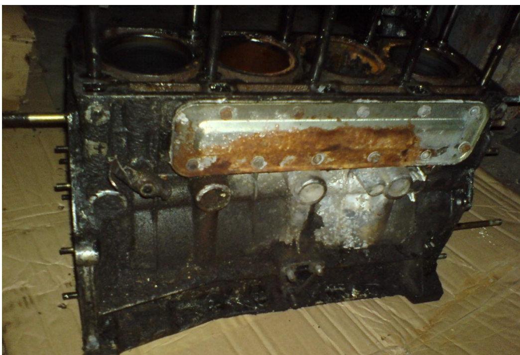
Şəkil 4.5. Korroziyaya uğramış mühərrik
