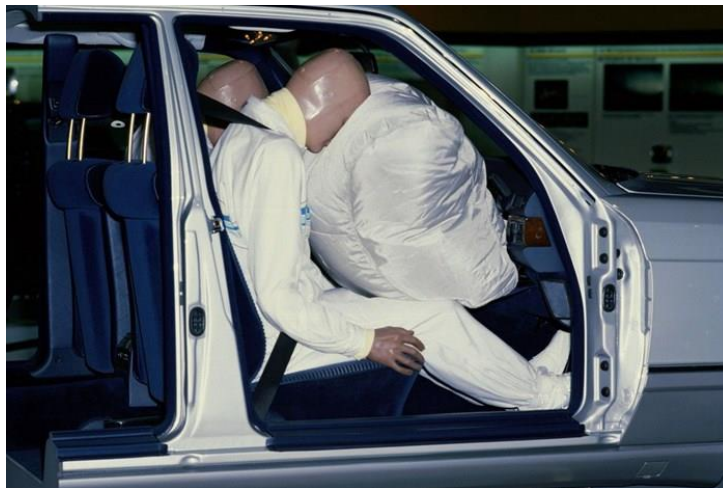
Şəkil 1.12 Qabaq hava yastıqlarının işi
